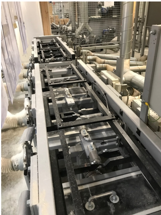
Figur 9 Anlæg til afvejning af fyldmateriale
