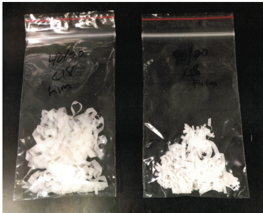
Figur 7 Skåret folie indeholdende PCM microkapsler. Folien blev fremstillet og testet i forskellige tykkelser. I folien indgår 50 % genbrugsplast.
