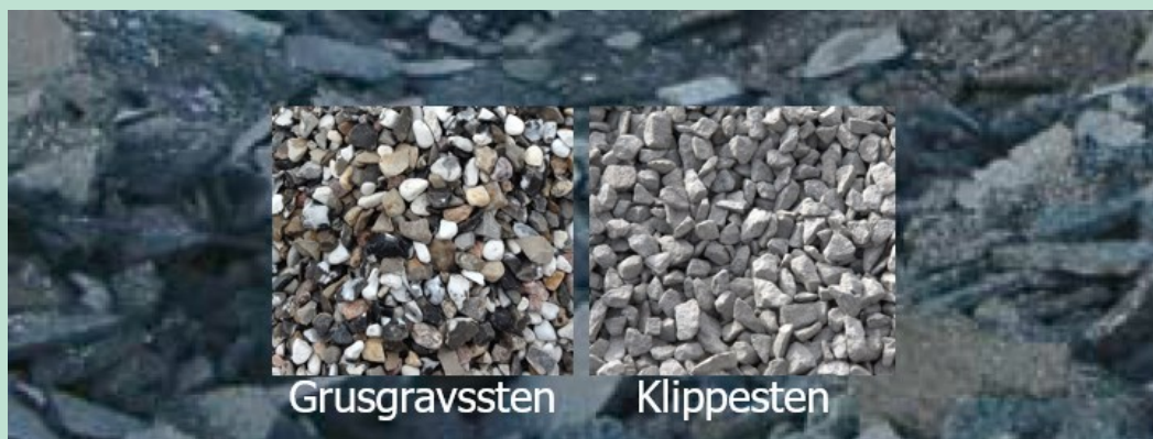
FIGUR 4.2.2. Genbrug fra gamle asfaltbærelag (GAB) indeholder typisk lokale grusgravssten, hvorimod asfaltslidlag typisk indeholder stærkere, knuste klippesten. (Foto: TI)
