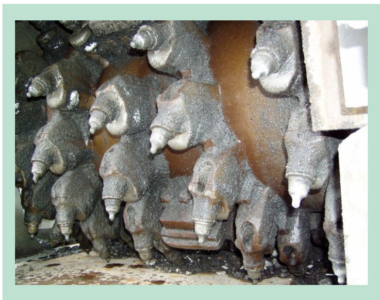
FIGUR 7.2.1. Nærbillede af normal fræsevalse med 15 mm linjeafstand. (Foto: Vejdirektoratet)
