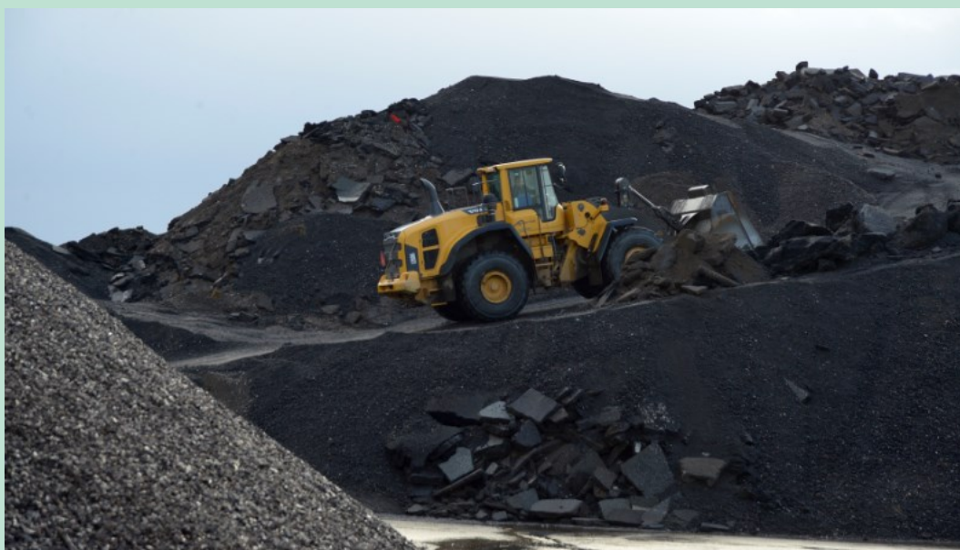
FIGUR 9.1.1. Oplag af ophugget/opfræset asfalt (t.h.) og oplag af knust genbrugsasfalt klar til asfaltproduktion (t.v.). (Foto: YIT)
