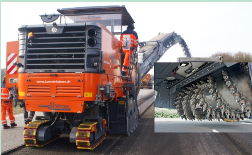
FIGUR 15.1.1. Fræsemaskine til affræsning af asfalt. Det lille indsatte billede til højre viser fræsevalsens "tænder", som "gnaver" asfalten bort (Foto: YIT)
