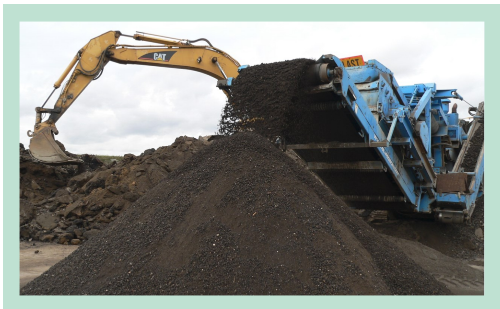
FIGUR 8.2.1. Den opbrudte asfalt knuses og opsigtes, så der opstår en ensartet råvare, der er velegnet som genbrugsasfalt tilsætning i produktionen af ny varm asfalt. (Foto: YIT)
