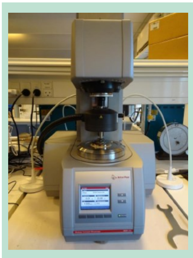
FIGUR 12.6.2 Dynamic Shear Rheometer (DSR) til bestemmelse af bitumenrheologi (foto: Vejdirektoratet)
