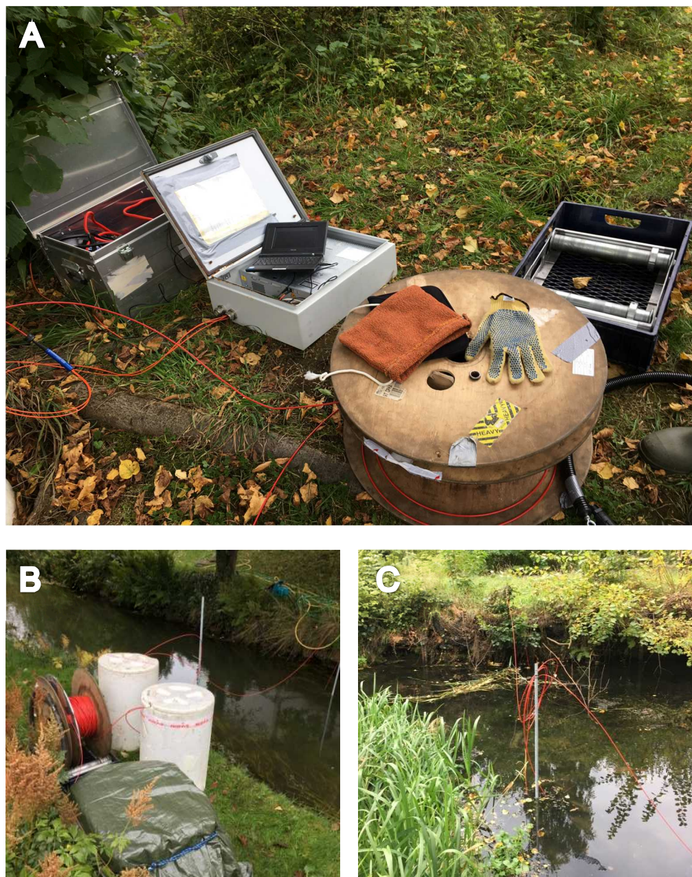
Figur 4. Udstyret til måling med DTS består af (A) et fiber optisk kabel (rødt kabel på tromle), et DTS-system med laser og computer (åben, grå boks) og strømforsyning (bilbatterier i aluminiumskassen). (B) Flamingotønder er benyttet til kalibrering af DTS-systemet inden opstart. (C) Ophæng af det fiber optisk kabel i luften over vandløbet som fikspunkt.
