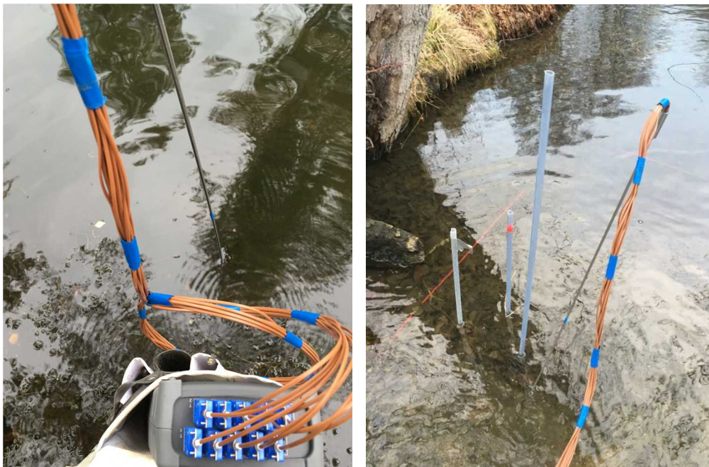
Figur 6. Foto viser den installerede Omega multipunkts temperaturprobe til måling af vertikale sediment-temperaturprofiler i de øverste 0,45 m af sedimentet under vandløbet.
