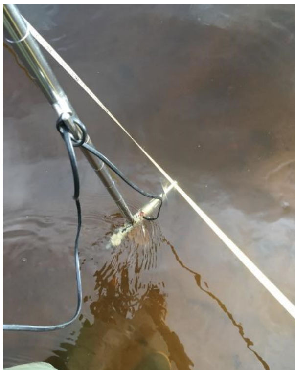
Figur 3.1 Billede af vingemåling. På billedet ses også målebånd til opmåling af vandløbsprofilet.
