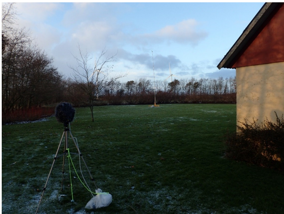
Figur 3. Udendørs måleposition PA4 og vindmåler ved bolig A
