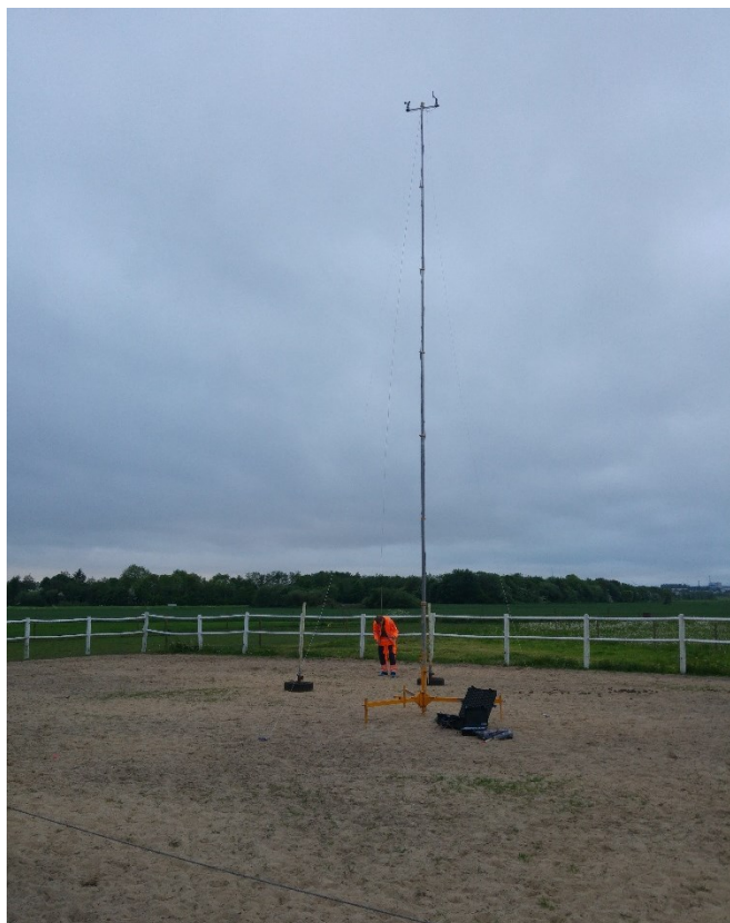
Figur 11. Eksempel på placering af vindmåler. Frit placeret i forhold til vindmøller og boliger.
