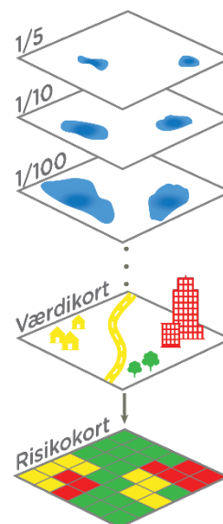
Figur 6 Risiko er et produkt af konsekvensen af en oversvømmelse over et antal sandsynligheder for oversvømmelse. Risikokortlægningen baseres på værdikort samt flere hydrauliske oversvømmelseskort.
