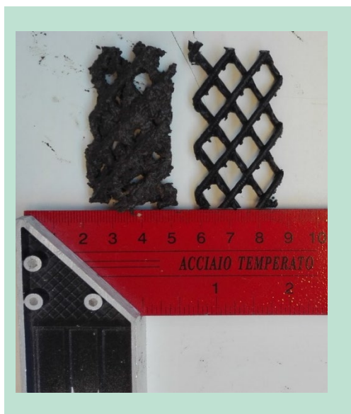
FIGUR 19. Overblik over biofilm på biomedierne før og efter rengøring.
