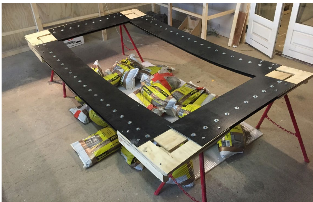
Ruden trukket ud af modulet liggende på gulvet, med sandsække ovenpå
