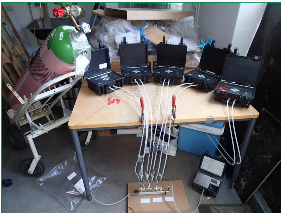
Foto 4.2. Forsøgsopstilling for standardgassen. Til venstre ses trykflasken med standardgassen og under bordet en 10 liter Tedlar-pose som buffer for trykfri prøveopsamling. På bordet står de nyeste Ripo-pumper (2. generation) til prøvetagningen på kulrør. Til højre under bordet ses pumpen som er forbundet til luftudtagning 7. Luftafkastet er ført uden for bygningen.
