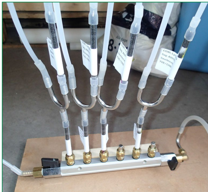
Foto 4.1. Opstillingen af kulrørene til anden prøvetagning d. 12. september 2017. Der er til højre opstillet et kulrør direkte tilkoblet manifolden og et B-rør til ALS. Til venstre er der tre kulrør direkte tilkoblet manifolden og tre B-rør til Højvang.
