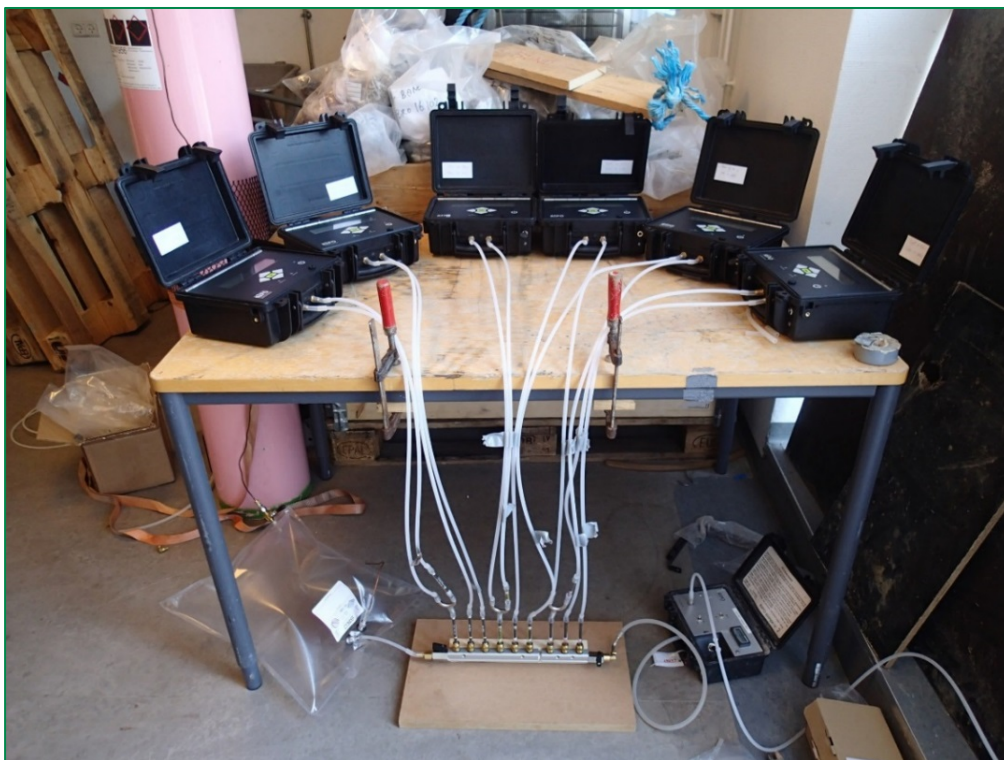
Foto 3.2. Forsøgsopstilling for standardgas 1. Til venstre ses trykflasken med standardgas 1, under bordet en 10 liter Tedlar-pose som buffer for trykfri prøveopsamling. På bordet står de nyeste Ripo-pumper (2. generation) til prøvetagningen på kulrør. Til højre under bordet ses pumpen (1. generations Ripo-pumpe), som er forbundet til luftudtagning 10. Pumpens luftafkast er ført uden for bygningen.
