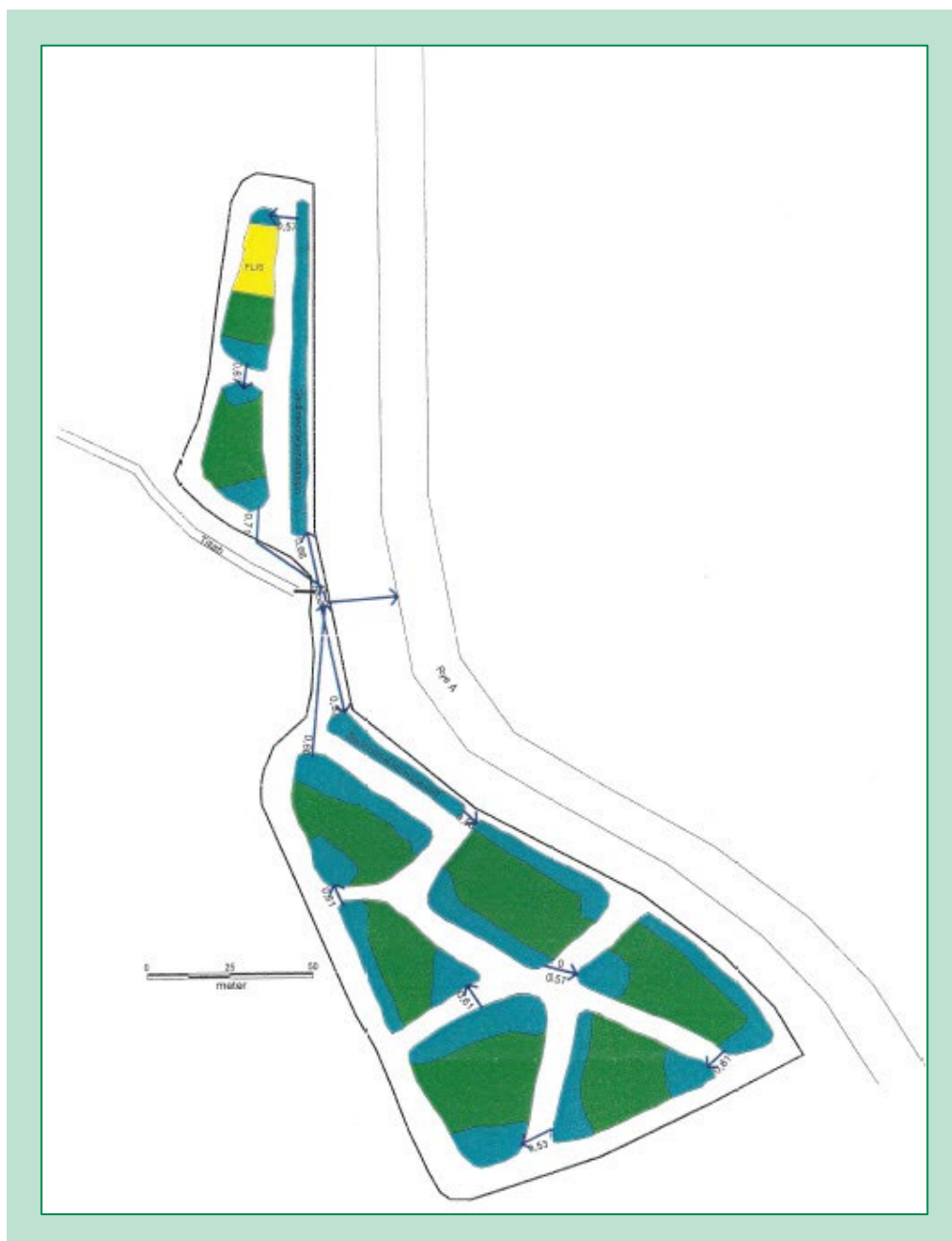
FIGUR 2.3.2. Plantegning (som udført) af de to minivådområder ved Gjør-Frstrup, matriveauet øverst og det åbne bassinanlæg nederst, med angivelse af strømningsvejene.
