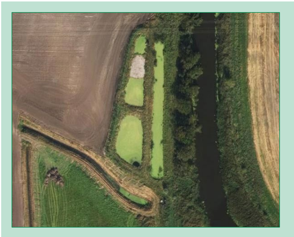
FIGUR 2.2.1 Luftfoto af matriceanlægget ved Gjøl-Fristrup 2017. Den grønne farve i bassinerne skyldes dækkende forekomster af Liden Andemad på vandoverfladerne. Det grå element er filtermatricen, bestående af grofthakket træflis.
