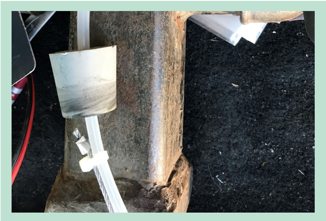
FIGUR 12. Fastsættelse af snor til datalogger under gummiprop
