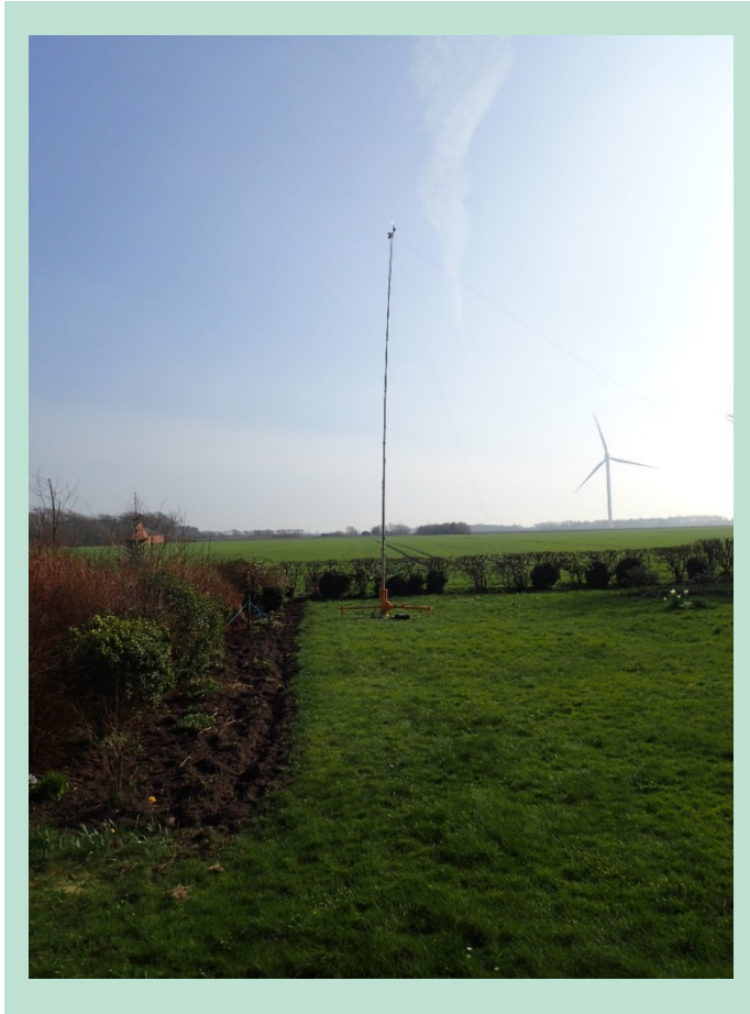
FIGUR 11. Eksempel på placering af vindmåler. Frit placeret i forhold til vindmøller og boliger.
