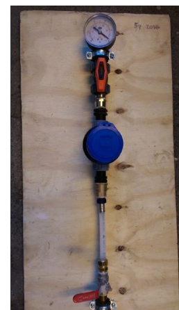
Test af distributionssystem Tryktest af samlinger udført i rødgoods.
