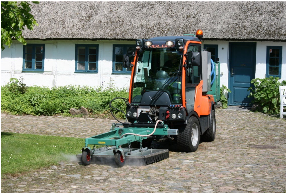
Billede 1. Eksempel på termisk metode til ukrudtsbekæmpelse. Dampning af pigstensbelægning, Furesø kommune (Foto: Anne Mette Dahl Jensen)
