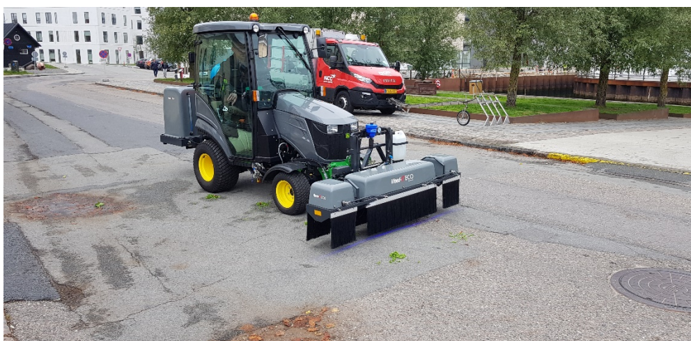
Billede 3. Demo af sensorbaseret sprøjte på temadag den 4 oktober 2018 i Odense, hvor WEED-it teknologien demonstreres på asfalt med udlagt græstotter (Foto: Anne Mette Dahl Jensen)
