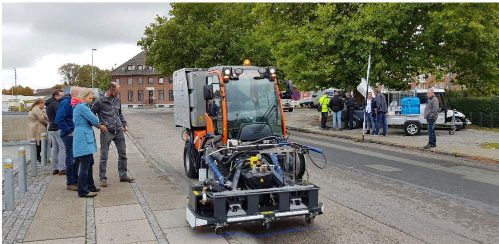
Billede 6. Sensor baseret Heatweed behandling (Foto: Anne Mette Dahl Jensen)
