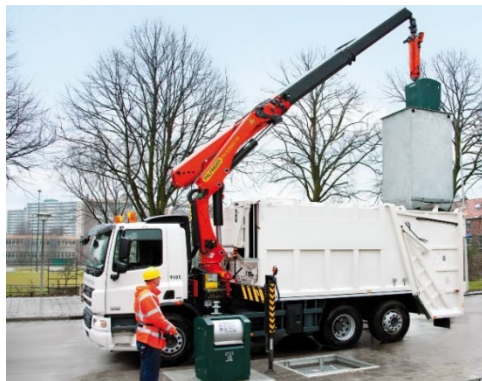
Tømming af pose fra delvist nedgravet beholder og af fast beholder fra fuldt nedgravet beholder
