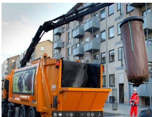
Tømming af pose fra delvist nedgravet beholder og af fast beholder fra fuldt nedgravet beholder
