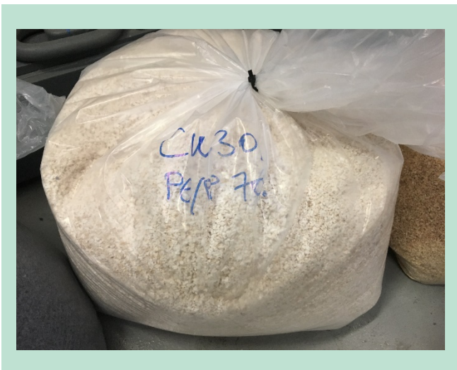
FIGUR 1: 30% hvid bomuld / 70% teknisk binder
