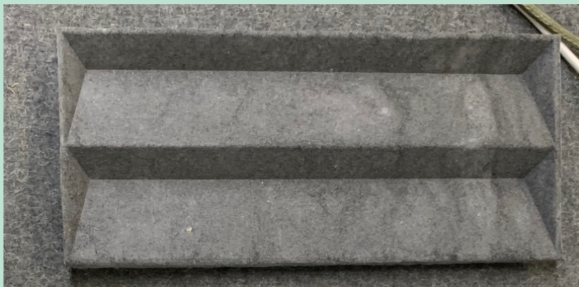
FIGUR 25: 30% teknisk binder + 70% grå uld tekstil fiber – hård presset
