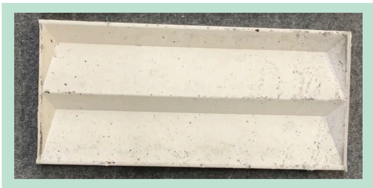
FIGUR 29: Display-produkt til briller i 70% hvid bomuld, 30% bico-fiber (hårdt presset)
