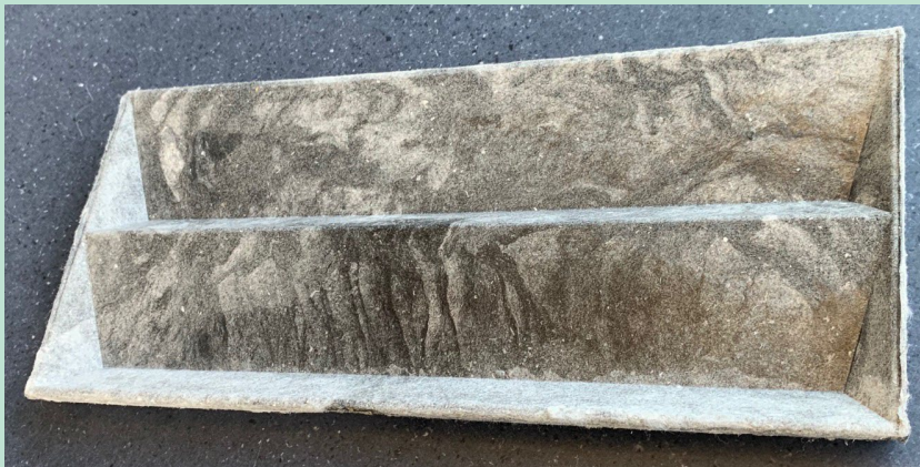
FIGUR 28: 30% Epoxy + 70% tekstil fiber (blandet hvid bomuld og grå uld)
