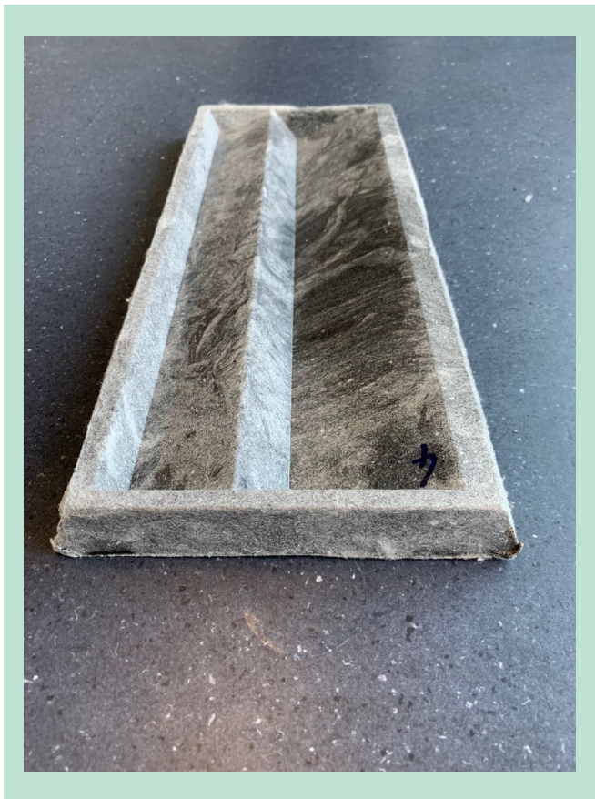
FIGUR 24: Emne med skrå vægge, uden skarpe kanter på undersiden og lukket ende.
