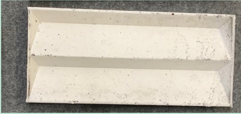
FIGUR 27: 30% teknisk binder + 70% hvid bomuld tekstil fiber – hård
