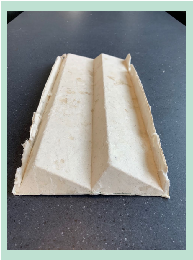
FIGUR 22: Emne med høje vertikale vægge
