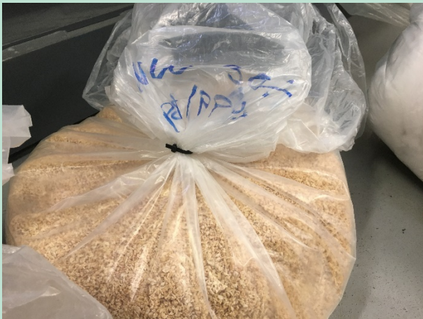
FIGUR 3: 30% natur uld / 70% teknisk binder
