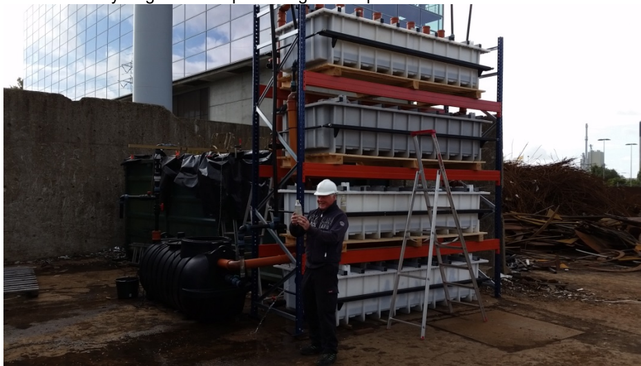
Figur 20: Foto af pilotopstilling til rensning af regnafstrømning fra skrotplads. De tre øverste bokse er DPF-bokse, mens nederste boks kun indeholder sorbent-materiale. Vandet løber i zig-zag-mønster fra øverste til nederste boks.
