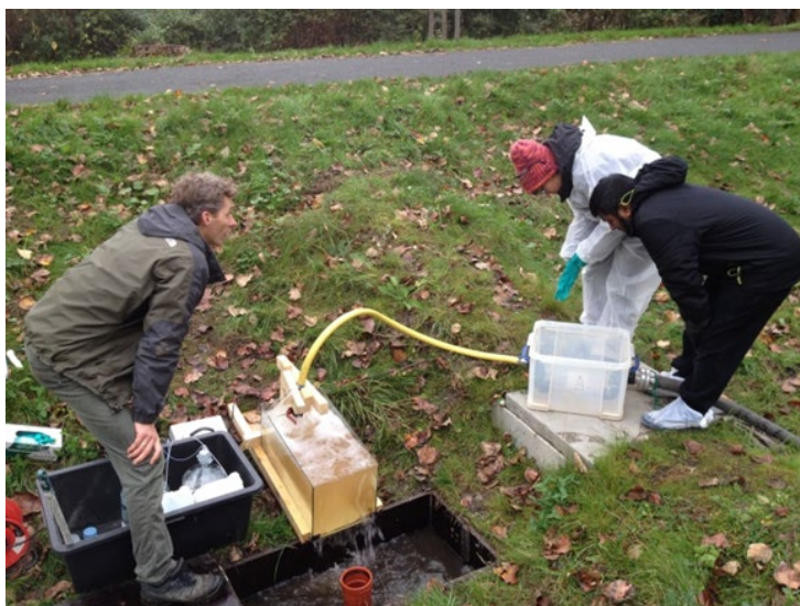
Figur 17: Tilsætning af puls til indløb til DPF-anlæg i Brønshøj. En cocktail af bekymrende stoffer tilsættes i høje, men realistiske koncentrationer til indløbet. Udløbskoncentrationer sammenlignes med indløb. Konservativ tracer benyttes til at kontrollere gennembrud og korrigere for evt. tab, der skyldes fortynding eller diffusion ud af systemet.
