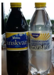
Figur 22: Foto af røggaskondensat fra Assens Fjernvarme før og efter rensning. Flasken til venstre indeholder råkondensat mens flasken til højre indeholder rensket kondensat. Rensningen bestod af bundfældning efterfulgt af rensning i 10 m langt DPF-anlæg.
