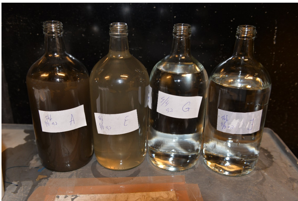
Prøver fra udvalgte rensesettrin blev analyseret for suspenderet stof. Gennemsigtigheden blev målt med et turbiditetsinstrument. Foto: Simon Skov
