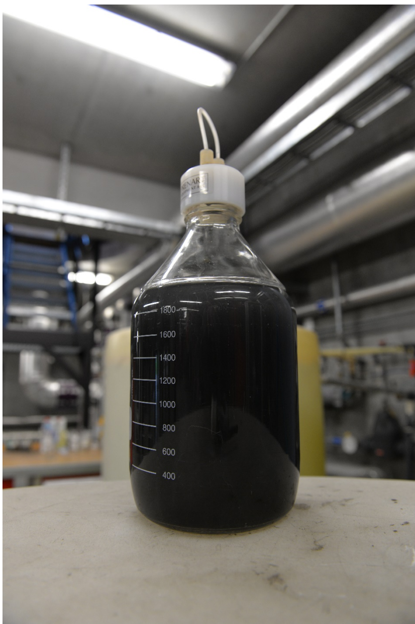
Råkondensat indeholder partikler (suspenderet stof) og opløste stoffer. Farven varierer fra grå til helt sort. Foto: Simon Skov
