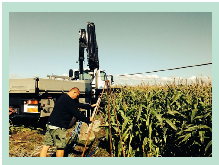
FIGUR 5.13 GEUS-tekniker ved opstilling til prøvetagning af grundvand til ^3\text{H}/^3\text{He} datering fra boring 159.1033 ved Bedsted. Dateringerne blev udført af Helium isotope studies (helis), University of Bremen. Prøverne blev udtaget i lange diffusionstætte kobberrør.
