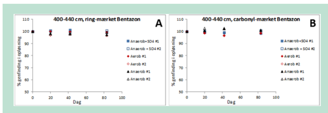
FIGUR 8.10 Fjernelse af bentazon i jord med lavt organisk indhold (400-440 cm) fra Løkken. Genfindning i væskefasen af ^{14}\text{C} - fra ^{14}\text{C} -bentazon mærket i den aromatiske ring (A) eller carbonylgruppen (B). TLC analyse viste ingen akkumulering af nedbrydningsprodukter ved forsøgets afslutning.
