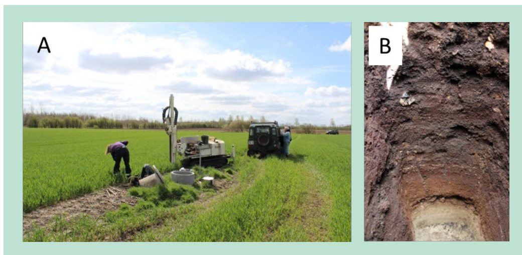
FIGUR 5.6. Prøvetagning ved Bedsted. A: Udtagning af sedimentkerner, B: Udgravninger hvorfra der blev udtaget overfladenære prøver
