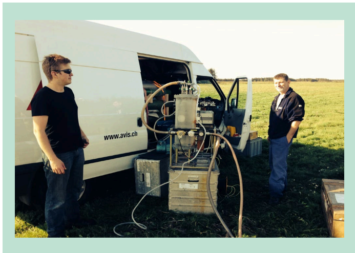
FIGUR 5.12 Tekniker og PhD studerende fra Climate and Environmental Physics, University of Bern ved opstilling til prøvetagning af de radioaktive ædelgasser ^{85}\text{Kr} og ^{39}\text{Ar} fra boring 8.222 i Løkken. Apparatet afgasser 2-4 m 3 grundvand før der er indsamlet tilstrækkelige mængder gas til måling af ^{85}\text{Kr} og ^{39}\text{Ar} .
