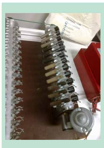
FIGUR 5.7. Bestemmelse af sorption - rotation af sorptionsrør
