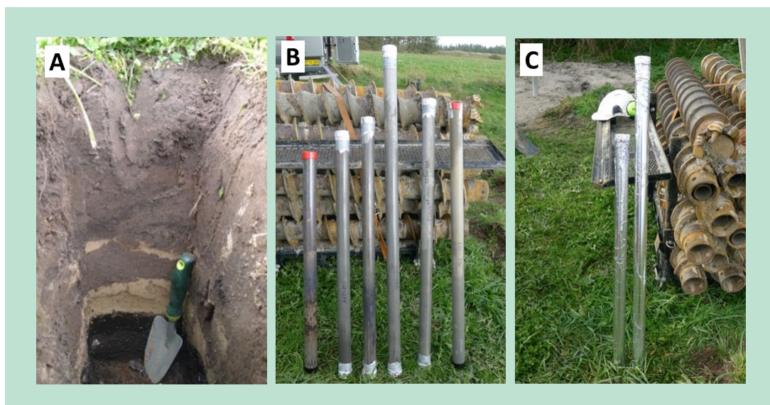
FIGUR 5.5. Sedimenter fra Løkken lokaliteten. A: Øverste jordlag B: Borekerner C: Borekerner indpakket i aluminiumstape for at holde dem iltfrie. Bemærk det mørke lag (55-65 cm dybde) i bunden af udgravningen (A)
