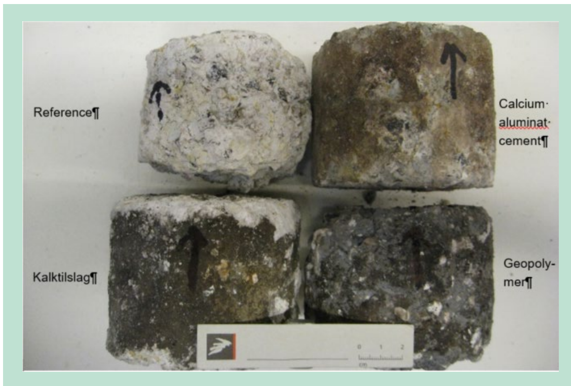
FIGUR 9. Felteksporerede prøver fra rørprojekt I.
