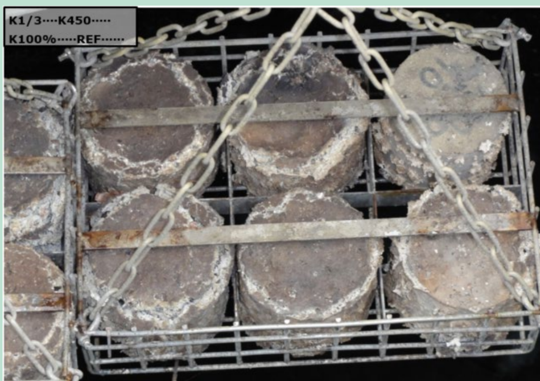
FIGUR 38. Nærbillede af buret til højre, jf. Figur 36, med prøver nedhængt i brønd ved Vestervej i Sønderholm efter 2 års eksponering (20-08-2019).
