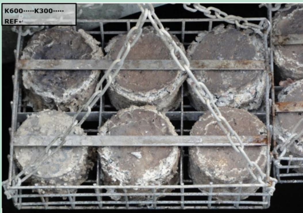
FIGUR 37. Nærbillede af buret til venstre, jf. Figur 36, med prøver nedhængt i brønd ved Vestervej i Sønderholm efter 2 års eksponering (20-08-2019).
