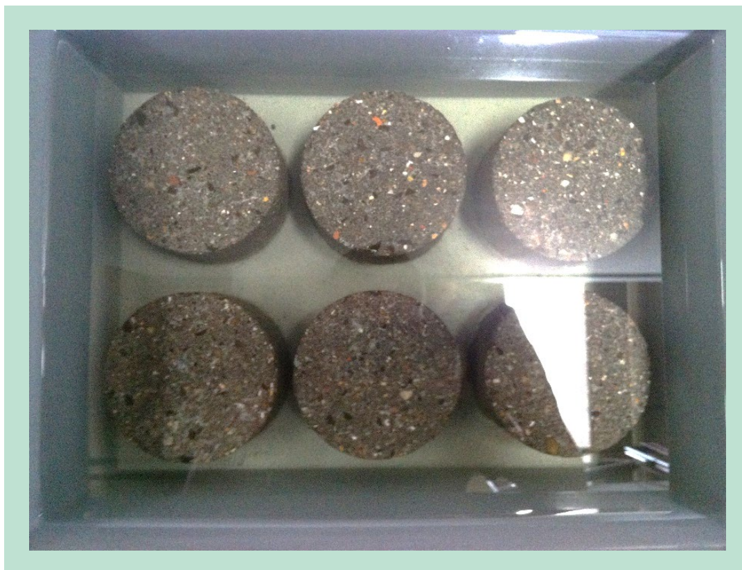
FIGUR 14. Kasse med prøveemner eksponeret i 1% svovlsyreopløsning.
