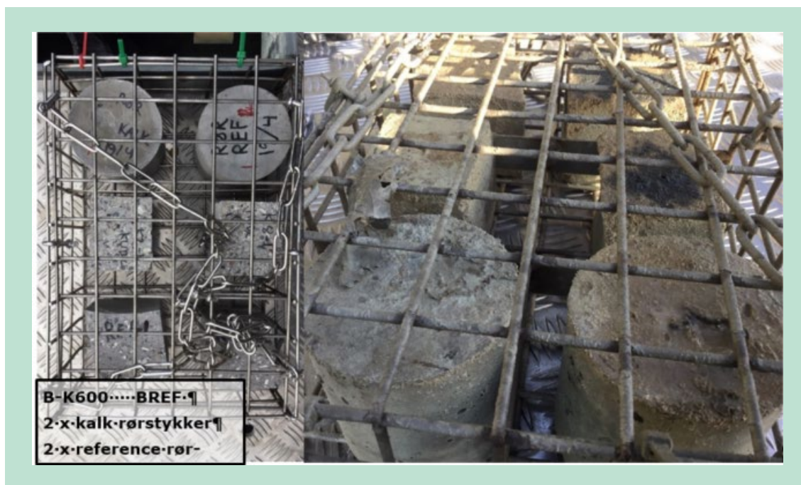
FIGUR 40. Prøver eksponeret i Juelsminde renseanlæg. Til venstre: 29-08-2019 (start eksponering). Til højre: 02-10-2019.
