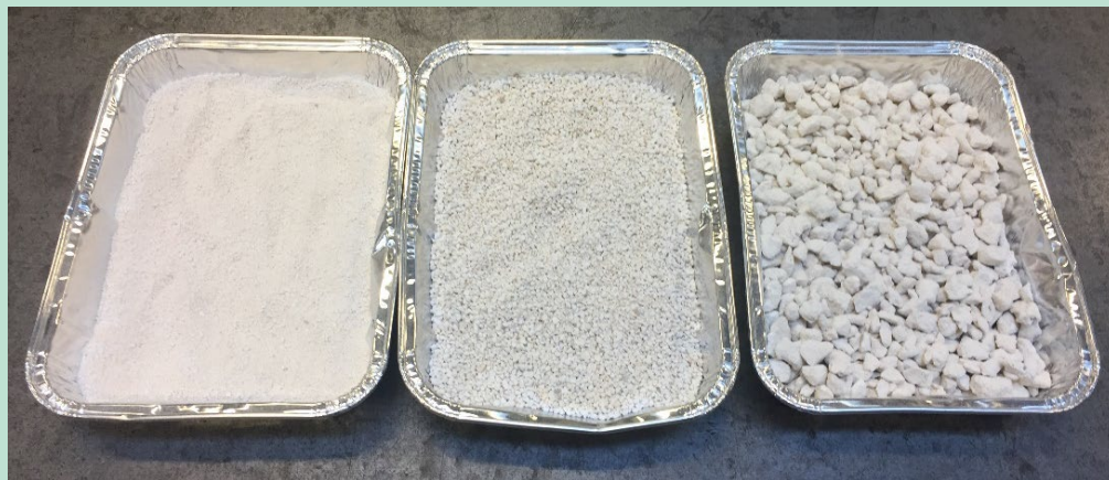
FIGUR 12. De anvendte kalkfraktioner, fra venstre 0/2, 1/3 og 7/12.
