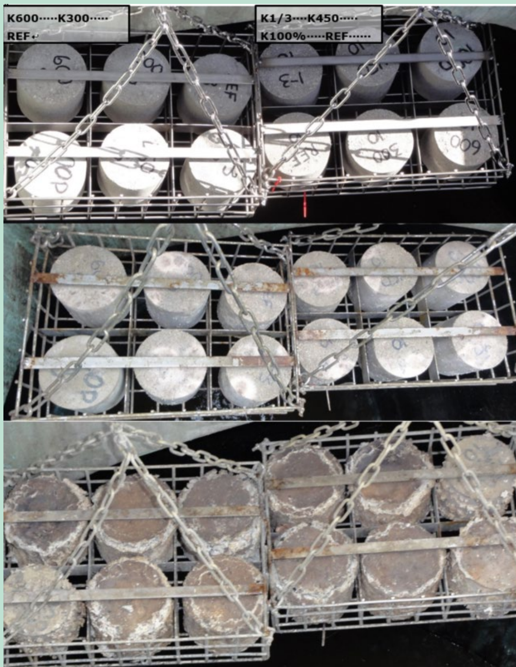
FIGUR 36. Prøver eksponeret i brønd ved Vestervej 61 i Sønderholm. Øverst: 16-08-2017 (start eksponering). I midten: 13-08-2018. Nederst: 20-08-2019.
