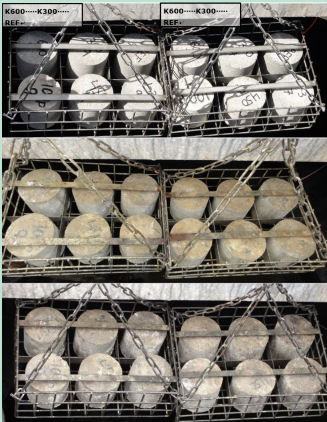
FIGUR 35. Prøver eksponeret i brønd ved Holmgårdsvej 58 i Ellidshøj. Øverst: 16-08-2017 (start eksponering). I midten: 13-08-2018. Nederst: 20-08-2019.
