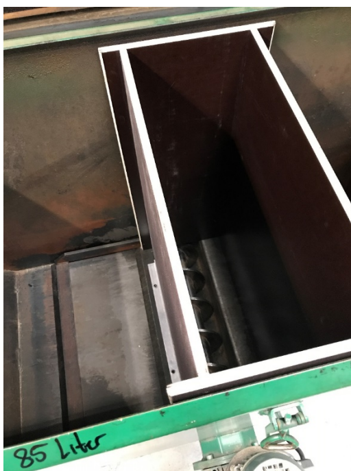
Special tilpasset beholder til substratet med 85 liters volumen. (Foto: Anders Pødenphant, Teknologisk Institut).
