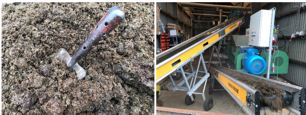
Sogylle-fiber før dobbeltskruepresning (t.v.) og under dobbeltskruepresning (t.h.). (Foto: Søren Ugilt Larsen, Teknologisk Institut).
