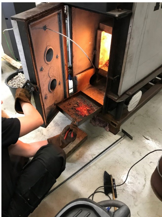
Billede af termofølerens installation gennem dør. (Foto: Morten Gottlieb Warming-Jespersen, Teknologisk Institut).
