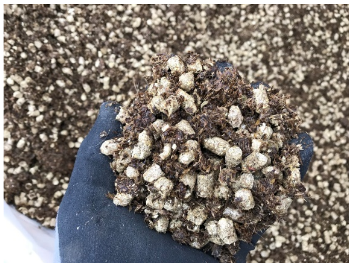
Blanding af sogylle-fiber og halmpiller umiddelbart efter opblandingen. (Foto: Søren Ugilt Larsen, Teknologisk Institut).
