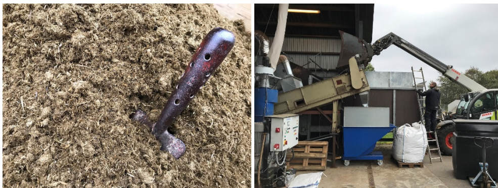
Biogas-fiber efter dobbeltskruepresning (t.v.) og under tørring (t.h.). (Foto: Søren Ugilt Larsen, Teknologisk Institut).
