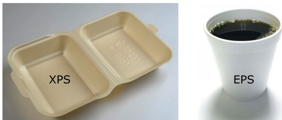
Figur 2. Fødevarer beholdere af XPS og en kaffekop af EPS. Kun EPS anses for nuværende at være omfattet af markedsføringsforbuddet under Engangsplastdirektivet (billeder fra Lassen et al. 2019)
