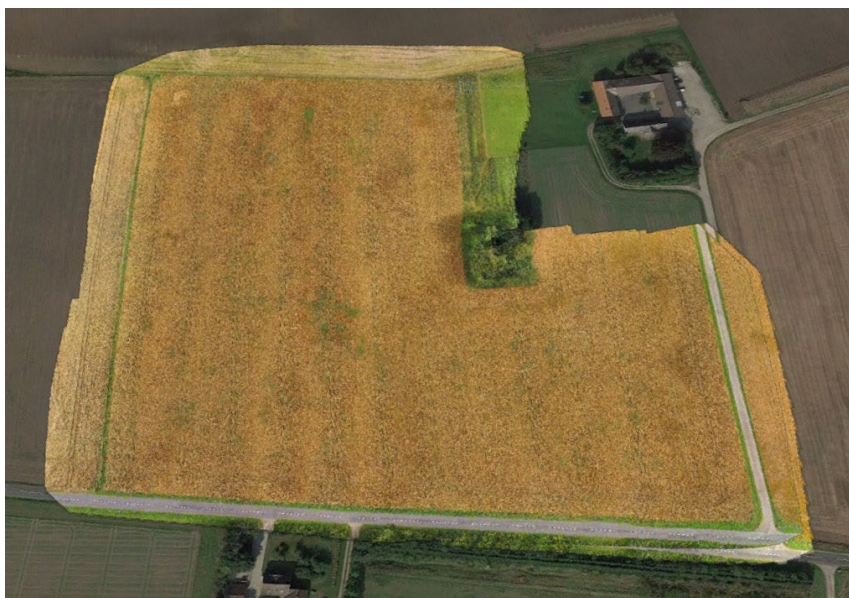
FIGUR 13. Ortomosaik dannet af billeder fra en Phantom 4 drone uden RTK-GPS. Det fremgår, at der er en vis unøjagtighed i forhold til det Google Maps kort, som mosaikken er lagt ned over. Se tekst for oplysninger om hvordan dette problem kan løses.
