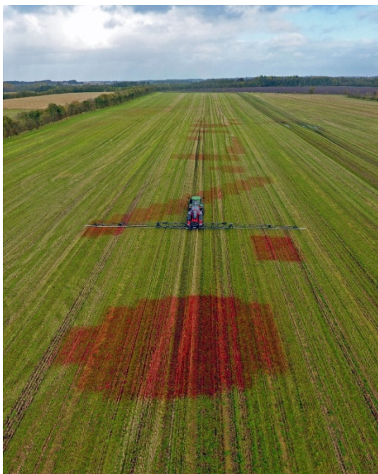
FIGUR 16. Pletsprøjtning med farvestoffet Ponceau 4R. Foran sprøjten er der sprøjtet en enkelt gang, og bag ved sprøjten er der sprøjtet to gange (fra test i Videbæk 2017).
