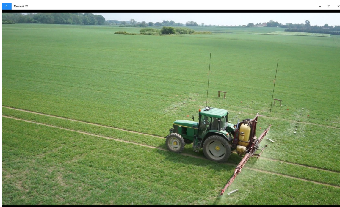
Billede 3. Oversigt over opstilling ved afdriftsforsøg. På fotoet passerer rækken af objekter opsat i køresporet til måling af afsætning under sprøjtebommen. Bagerst i billedet ses rækker af objekter til opsamling af sedimentationsafdrift samt master til opsamling af luftbåren afdrift.
