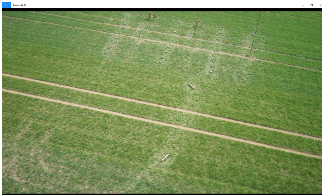
Billede 2. Luftfoto af opstilling ved afdriftsforsøg. Forrest kørespor med objekter opsat i vindside og læside. Bagerst i billedet objekter til opsamling af sedimentationsafdrift i 3 rækker med målepunkter i stigende afstand fra det sprøjtede kørespor. Bagerst tre rækker med master placeret 5 meter fra det sprøjtede areal.
