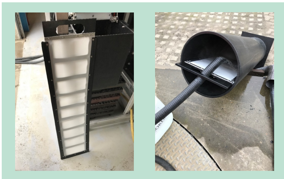
FIGUR 38. Til venstre: Filterdugen som udløbsvandet fra separationsanlægget passerede over under spikingforsøget. Til højre: Filteranordningen, som den blev anvendt under forsøget.
