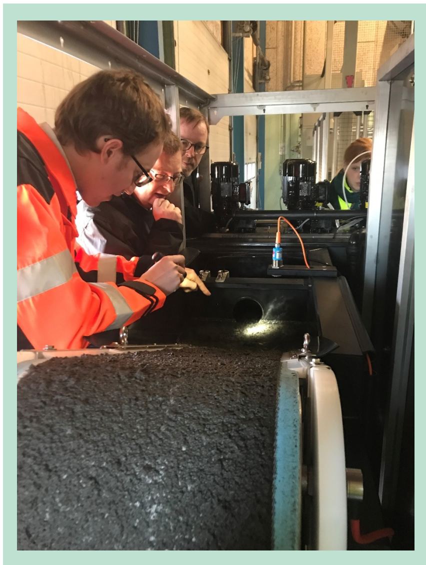
FIGUR 35. Ved pilotforsøg på Berendsens måttevaskeri i Karup viste separationsanlægget rigtig gode resultater ift. at danne og efterfølgende tilbageholde slamflokke på båndfilteret.
