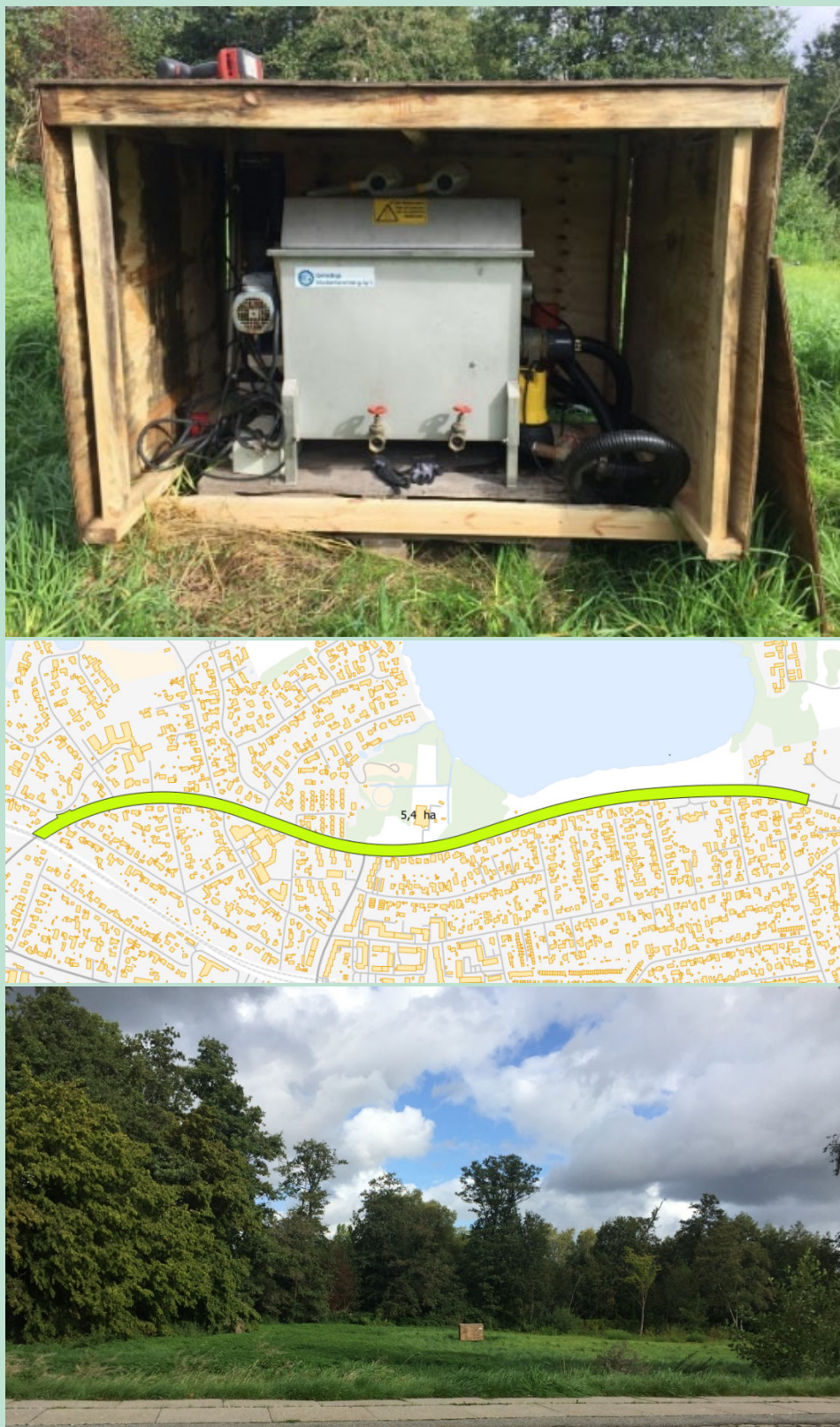
Figur 32. Øverst ses pilotanlægget, som blev indbygget i en trækasse ved test i Bagsværd, da anlægget stod i et åbent miljø. I midten ses et kort over oplandsarealet, som leder regnvand til vejvandsbrønd BSR0100. Nederst ses selve testsitet.
