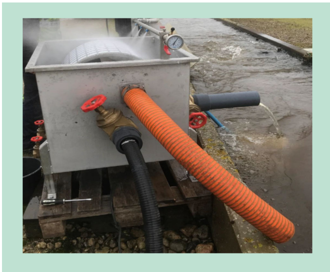
Figur 28. Pilotanlægget med 10 µm filterdug kunne i performancetest med vand fra Varde Å tilbageholde partikulært materiale, herunder mikroplast og -gummi, mens det rensede vand passerede igennem. En del af det rensede vand blev efterfølgende ledt til dyserne og brugt til at renholde filterdugen.
