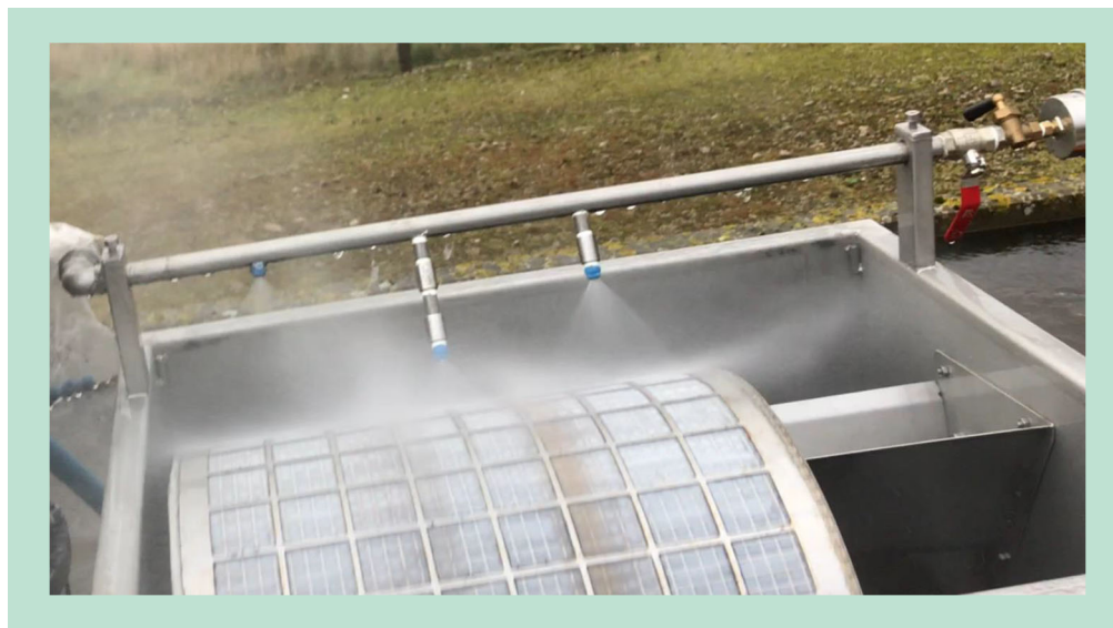
Figur 27. Returspulingen af filterdugen blev udfordret af det fine filtervæv pga. større modstand i filteret. Udviklingen af et egnet spulesystem fokuserede derfor på at optimere både vandtryk og afstanden mellem dyser og filterduk.
