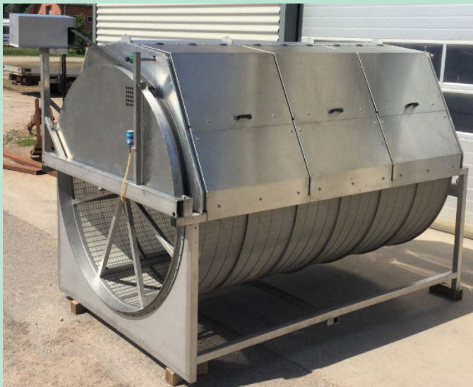
Figur 25. Mikrotromlesigte fra Grimstrup Maskinforretning i fuld størrelse.
