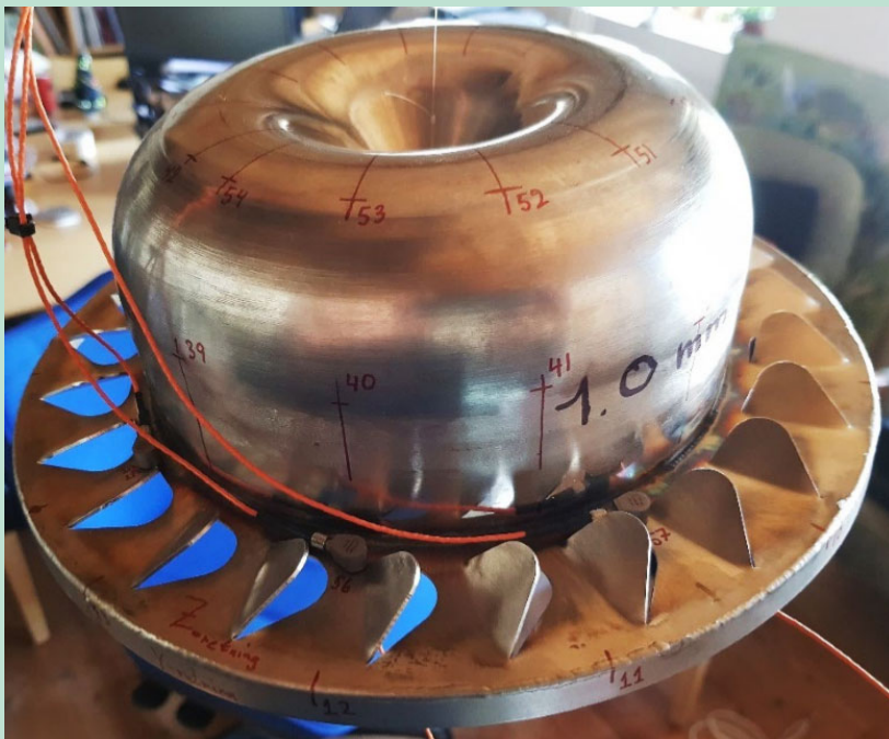
FIGUR 66. Et eksempel på en 1,0mm Swirling baffle med punkter markeret med et identifikationsnummer
