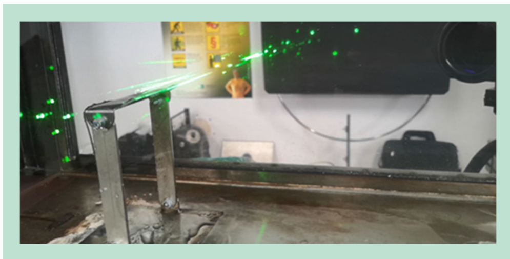
FIGUR 50. Mixerplade testene blev foretaget i vindtunnelen ved PDA-målinger og temperaturmålinger af selve plade element.
