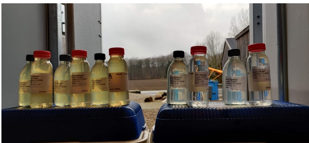
Testvand ved Region Sjælland-testen. Til venstre ses vandprøver efter behandling/oxidation og til højre vandprøverne fra før behandling
