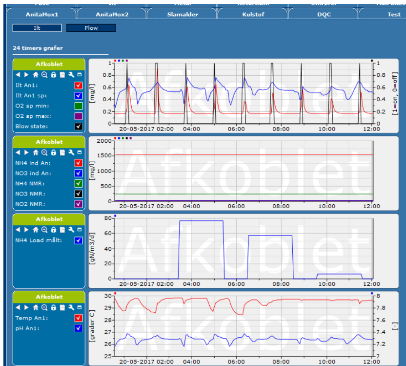
FIGUR 14. Behandlede online data relateret til beluftningsstyring af anammoxprocessen vises i STAR brugerfladen
