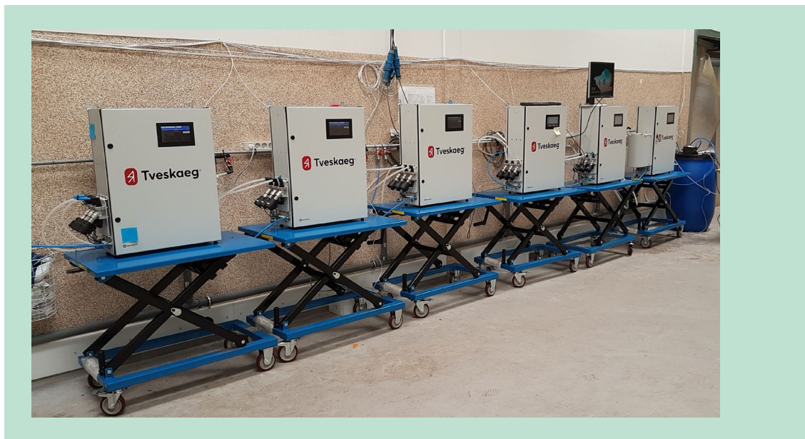
FIGUR 18. NMR-måler opstilling til test og kalibrering hos NanoNord.
