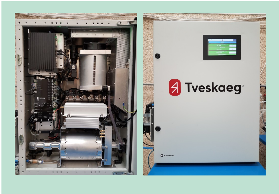
FIGUR 5. NMR-målerkabinettet; Lukket til venstre og åbent til højre. Inde i kabinettet ses NMR-magnet i bunden af billedet samt skyllesystem øverst i kabinettet.
