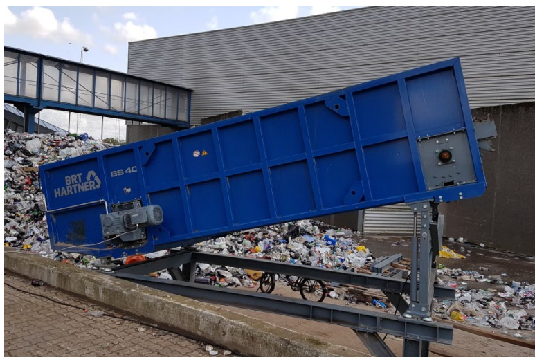
FIGUR 15 Viser den ballistiske sigte, der kan adskille 2D og 3D fraktionen fra hinanden.
