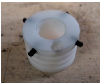
FIGUR 13 Ny bøsning, fæstnes med pinolskruer og udformet med riller til påsætning af sugehoved.
