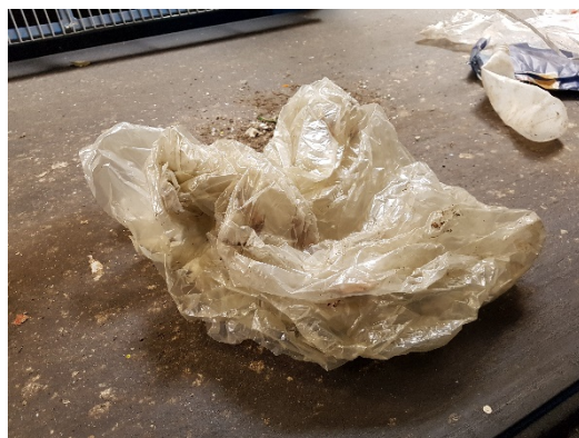
FIGUR 3 Foldet LDPE som NIR-kamera kan forveksle med HDPE
