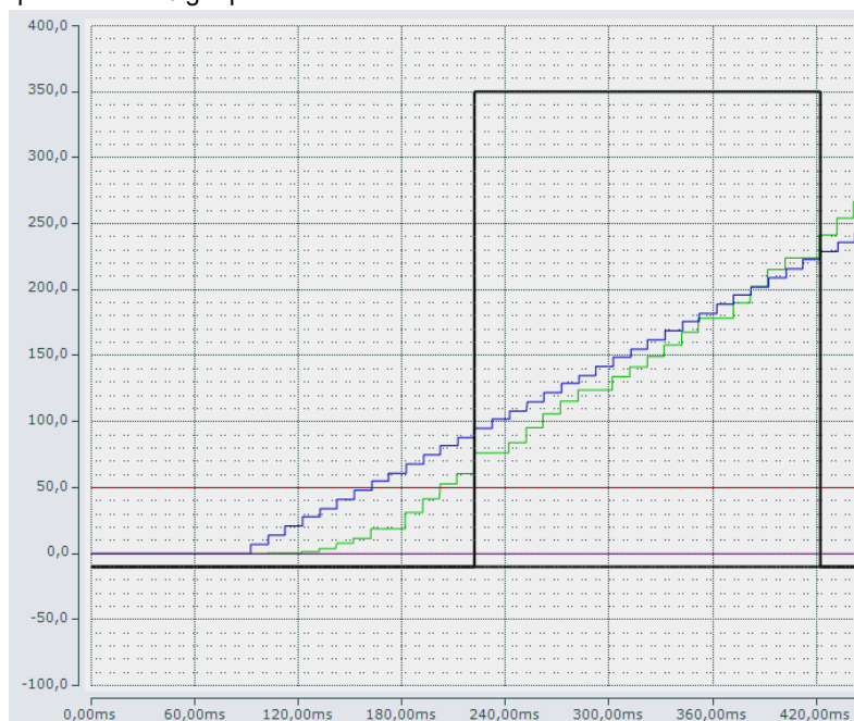
FIGUR 29 Viser inden optimering, robotens bevægelse (grøn) og båndets bevægelse (blå) over tid, i perioden hvor robotten samler emnet op, indikeret af den sorte ramme.
