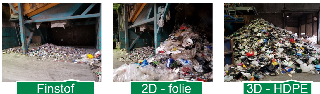
FIGUR 6 Viser plast fra husholdning fra Nomi4s området, sorteret i 3 fraktioner af en ballistisk separator.
