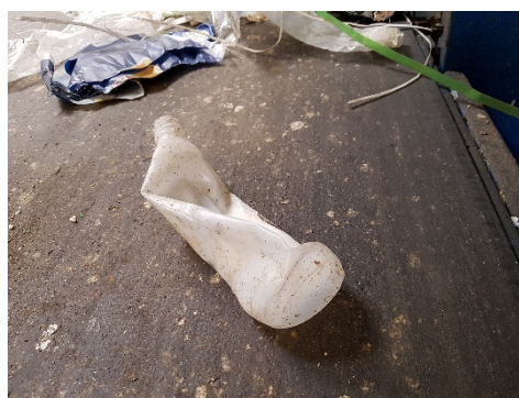
FIGUR 4 Viser t.v. scenariet, hvor to emner kan blive genkendt som ét emne, og vil derfor gribe ned imellem de to. T.h. et uhomogent emne, som robotterne har svært ved at gribe.
