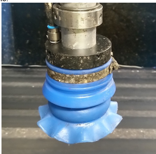
FIGUR 14 Ny bøsning og sugehovede monteret på gribearm.
