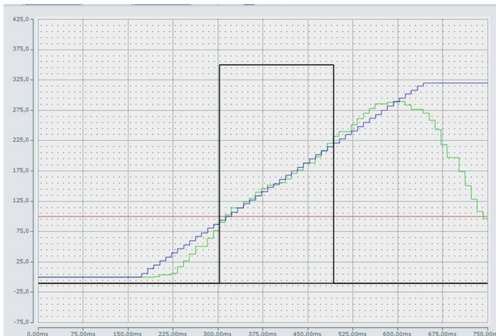
FIGUR 31 Viser efter optimering, robotens bevægelse (grøn) og båndets bevægelse (blå) over tid, i perioden hvor robotten samler emnet op, indikeret af den sorte ramme.
