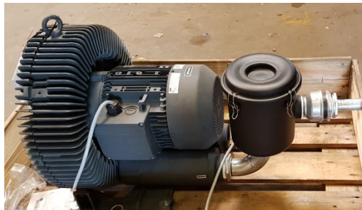
FIGUR 8 Samos 0530, som indgik i en test for øget gribesikkerhed af emner og som har et ca. dobbelt så stor volumen flow som eksisterende pumpe.
