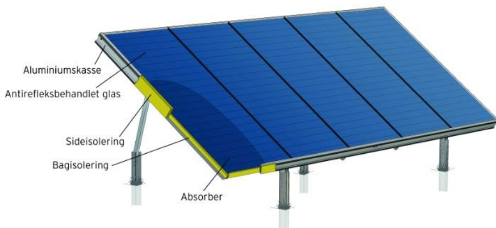
FIGUR 3. Eksempel på opbygning af en panelsofanger (HT HEATBoost fra Arcon Sunmark) (Arcon-Sunmark, 2020a).
