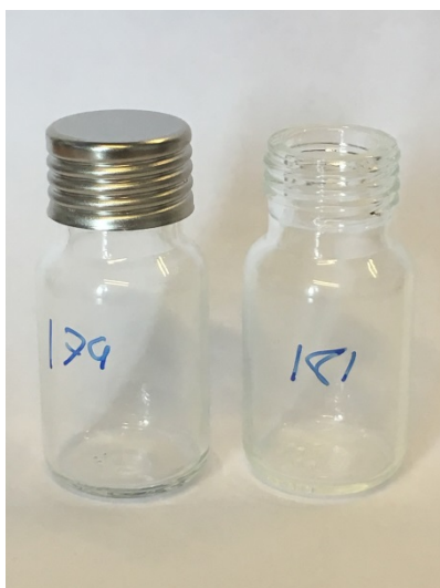
FIGUR 3.4 10 mL glas (Mikrolab, Århus) brugt til støbning af silikone og silikonestave ladet med cypermethrin til PDM.
