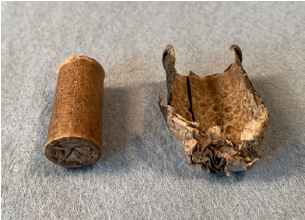
FIGUR 9. Haglskål af papir. Til venstre ses den ubrugte haglskål. Til højre set en haglskål efter affyring. Man ser tydeligt mærkerne efter haglene på væggen på den afskudte haglskål. I den ubrugte haglskål, er der ikke disse mærker.
