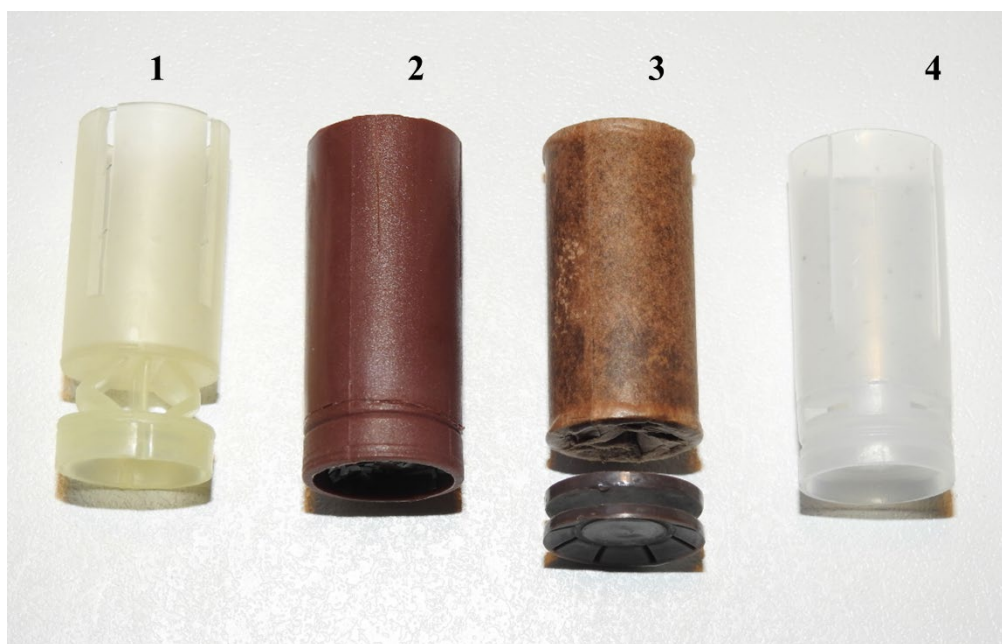
Figur 3. De fire typer af haglskåle: Fra venstre: 1: Bionedbrydelig vandopløselig, 2: bionedbrydelig solid, 3: bionedbrydelige fiber med gaspakning og 4: traditionel ikke-nedbrydelig solid type (oftest PE).
