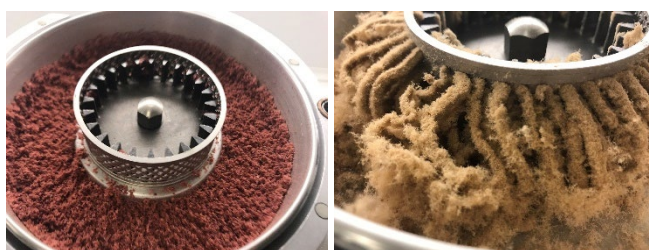
FIGUR 11. Mekanisk neddeling af papirfiberhaglskålen (til højre) resulterede i lange fibre, i mod sætning til de termostøbte haglskåle, som PHA (til venstre).
