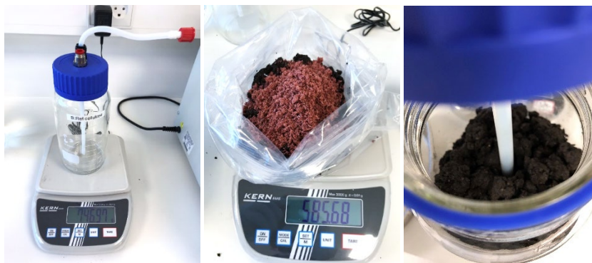
FIGUR 13. Venstre: Kompostbeholder. Midt: Blanding af neddelte haglskåle med kompost. Højre: Lukning af kompostbeholder.
