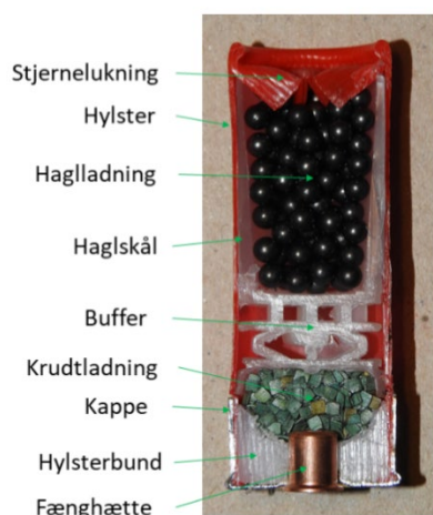
FIGUR 1. Tværsnit af en haglpatron
