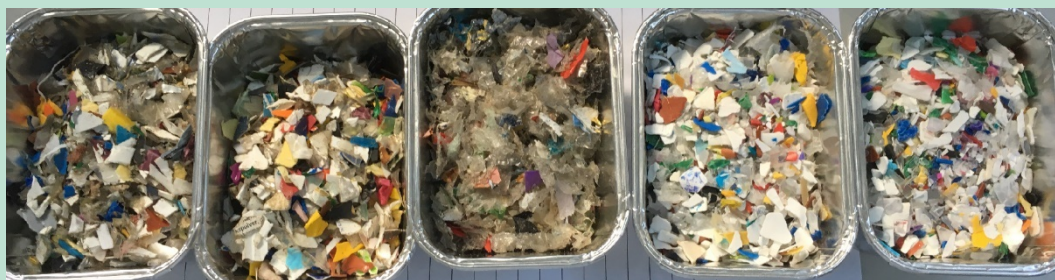
FIGUR 11. Udviklingsforsøg nr. 13 PP 2X Reno-Nord. Fra venstre mod højre: Input, hård plast (folierenset), folie, vasket plast, densitetssorteret tørret PP-produkt.
