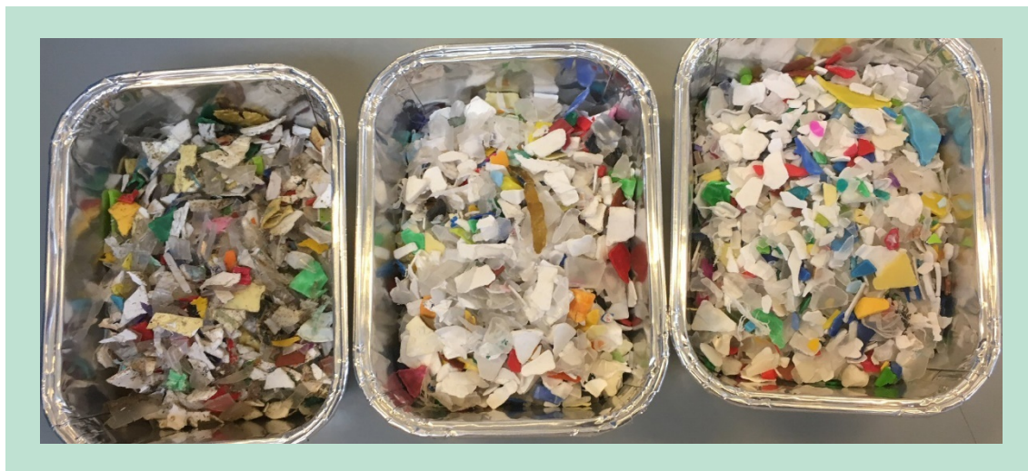
FIGUR 10. Udviklingsforsøg nr. 6 HDPE Nomi4s. Fra venstre mod højre: Input, vasket, densitetssorteret og tørret HDPE-produkt.
