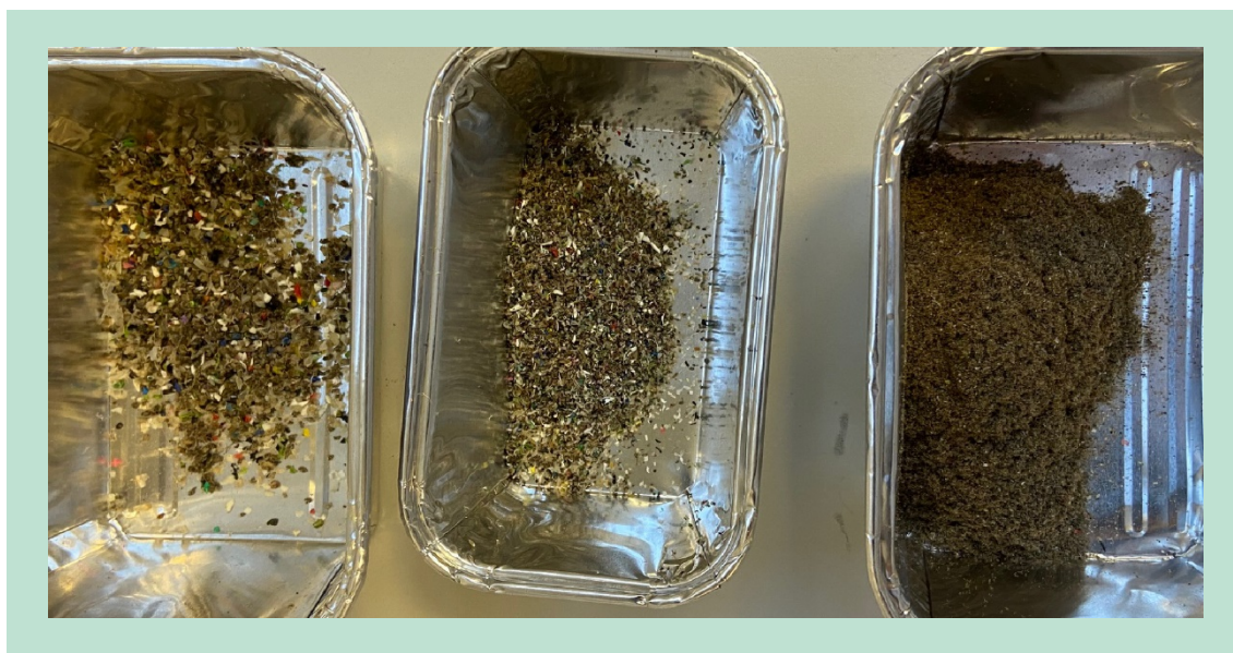
FIGUR 17. Separeret slam fra vask af HDPE ARC 2X, type 2. Fra venstre mod højre: A: >710 \mu\text{m} , B: 355-710 \mu\text{m} , C: <355 \mu\text{m} (bestemt plastindhold = 47 % ud af TS).
