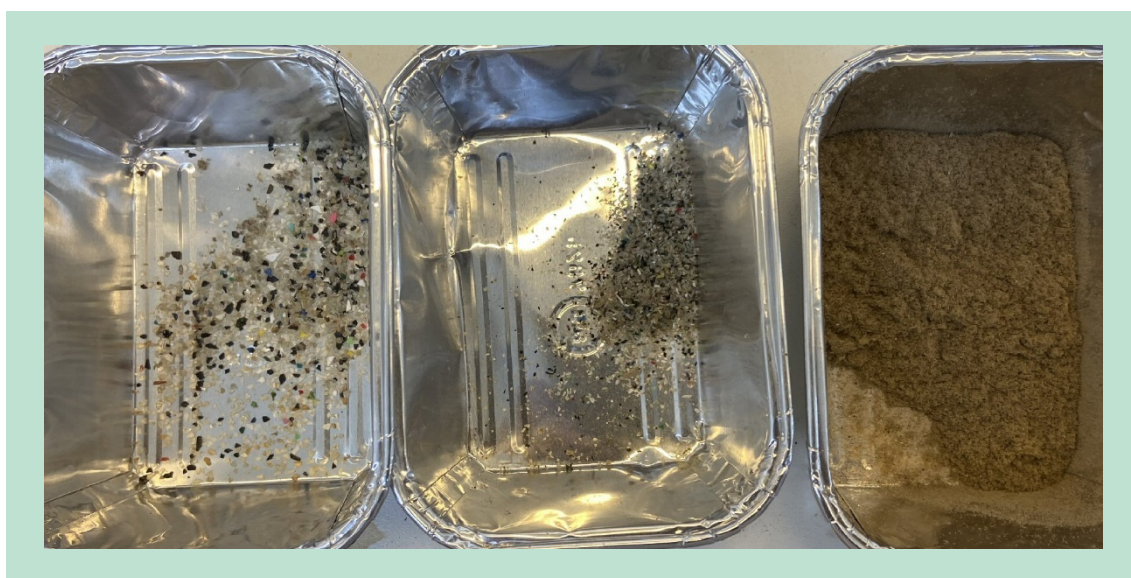
FIGUR 19. Sorterede fraktioner af tørret slam PET 2X ARC, type 2. Fra venstre mod højre A: >710\ \mu\text{m} , B: 355\text{-}710\ \mu\text{m} , C: <355\ \mu\text{m} (bestemt plastindhold = 40 % ud af TS).
