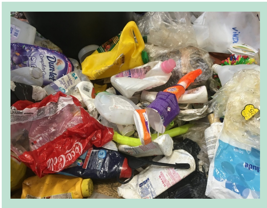
FIGUR 46. HDPE én gang oprenset med en del indhold af folie
