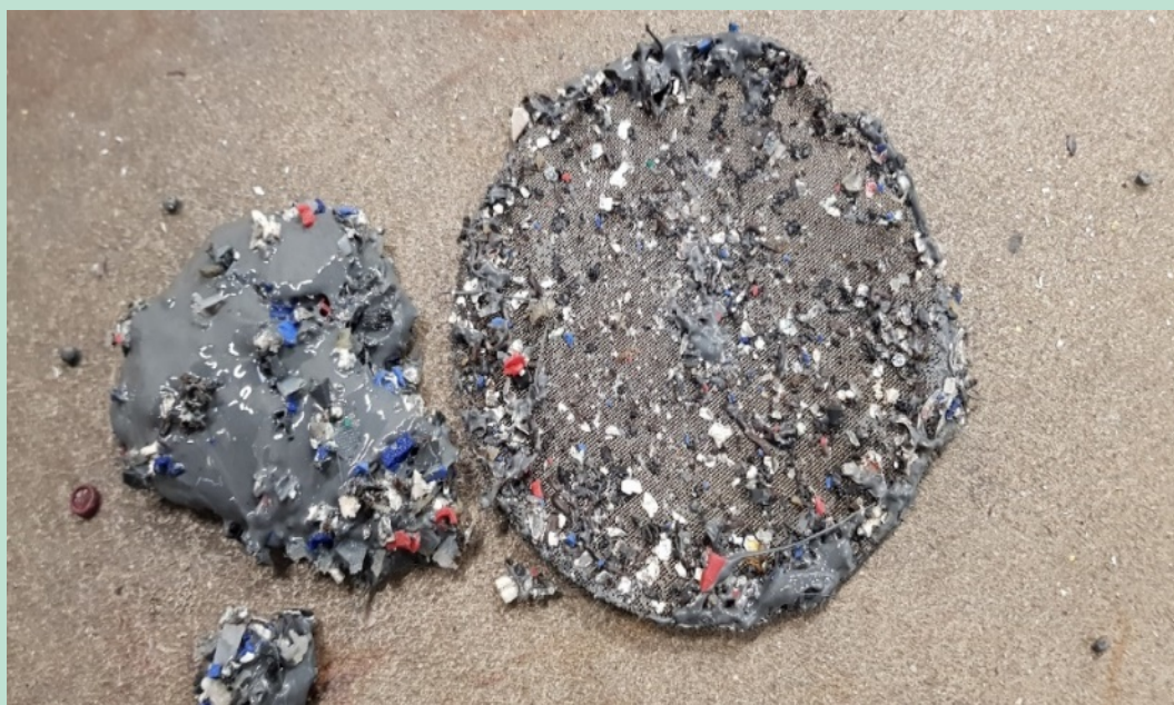
FIGUR 12. Smeltefilter (mesh 40) fra ekstrudering af PP Nomi4s (forsøg nr. 1).
