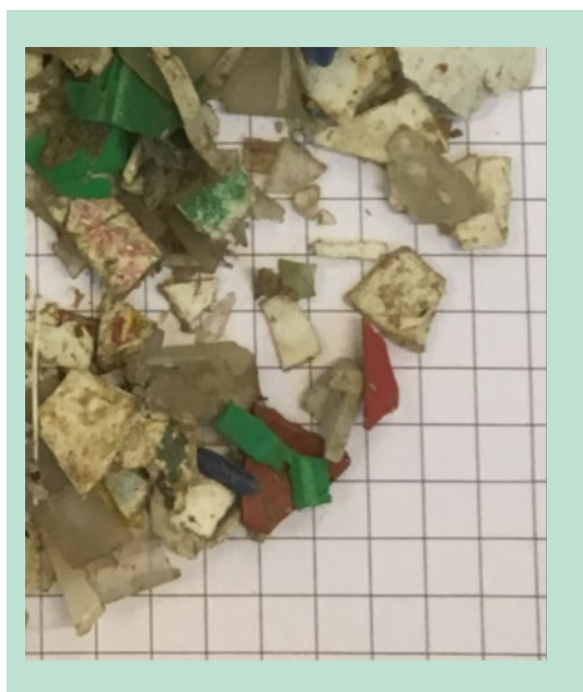
FIGUR 59. Materiale neddelt med brug af 10 mm sold
