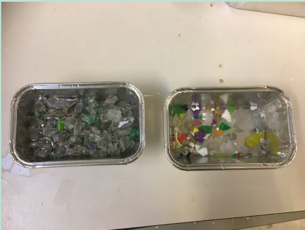
FIGUR 26. Separation af tung PET (tv) og let plast (th) efter manuel separation af lag i delvist delaminerede PET-flager.
