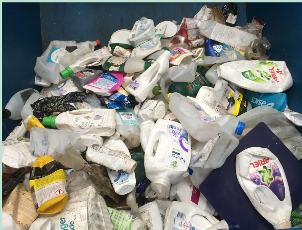
FIGUR 56. HDPE efter fjernelse af folier.
