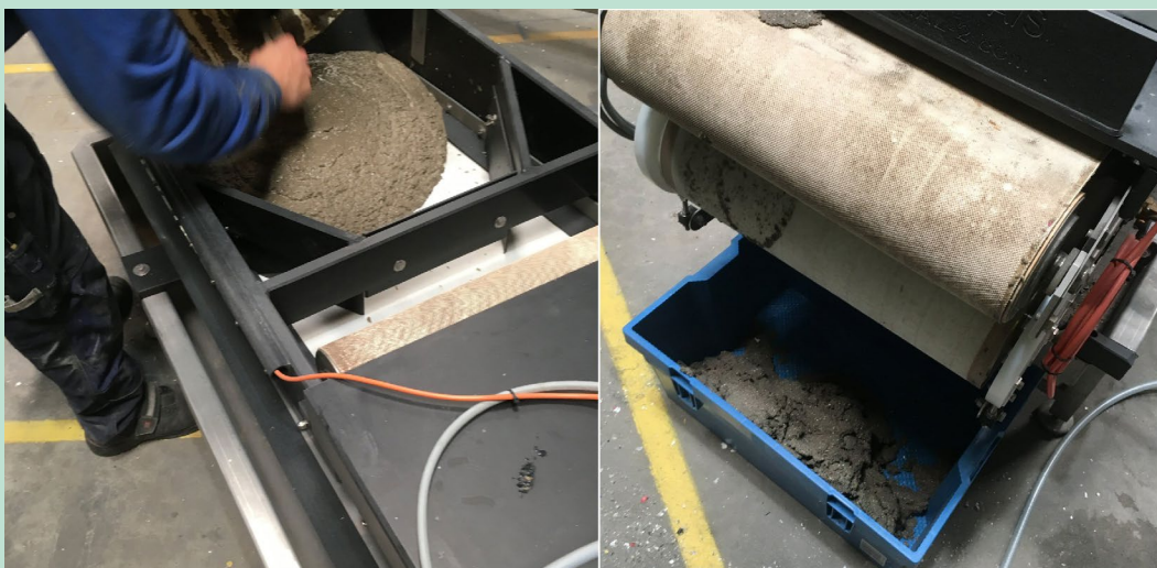
FIGUR 20. Indledende forsøg med båndfilter. Til højre: Tilført spildevandspulp. Til venstre: Fraseparere filterkage.
