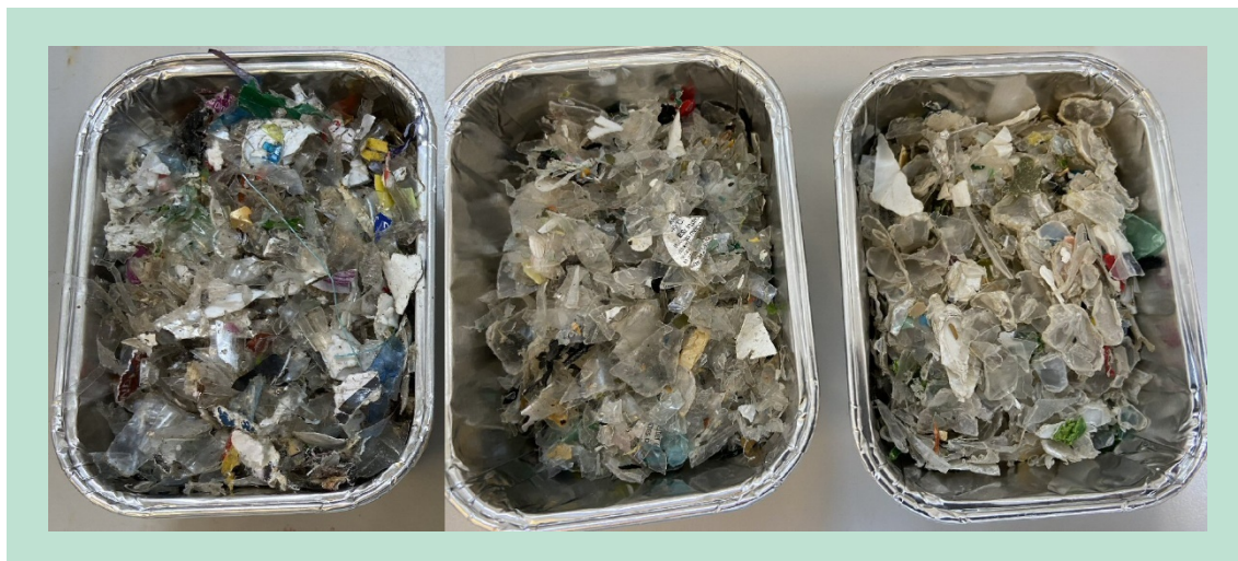
FIGUR 15. Forsøg nr. 15, PET 2X ARC. Til venstre mod højre: Input, vasket PET, densitetssorteret og tørrenset/tørret PET.
