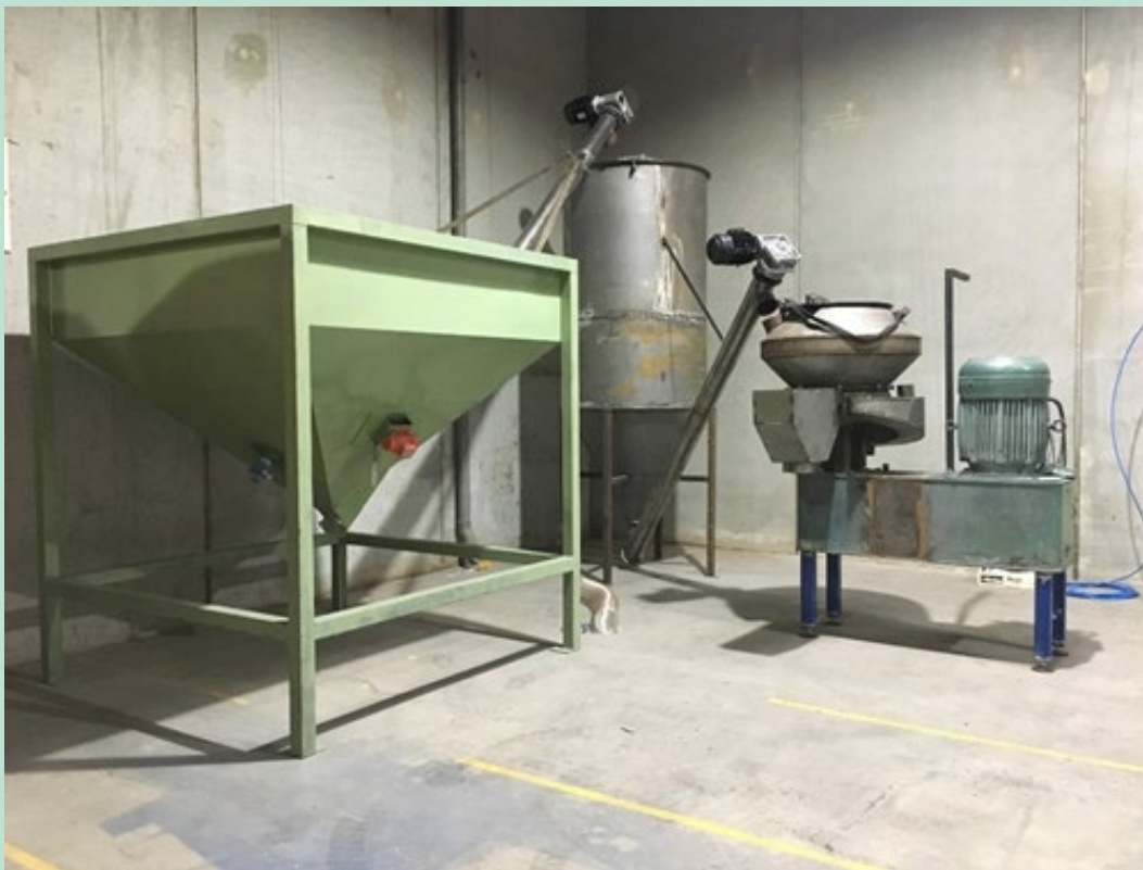
FIGUR 7. Vaskeenhed i pilotskala.
