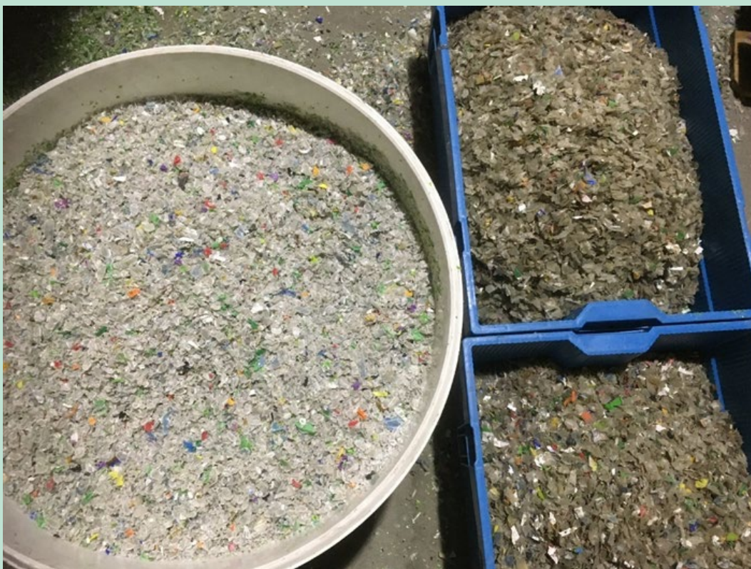
FIGUR 24. Til venstre: Vaskede flakes. Til højre: Input.
