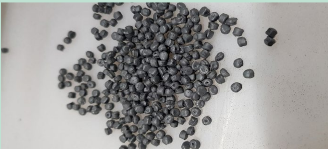
FIGUR 13. Ekstruderede piller af PP (forsøg nr. 1).
