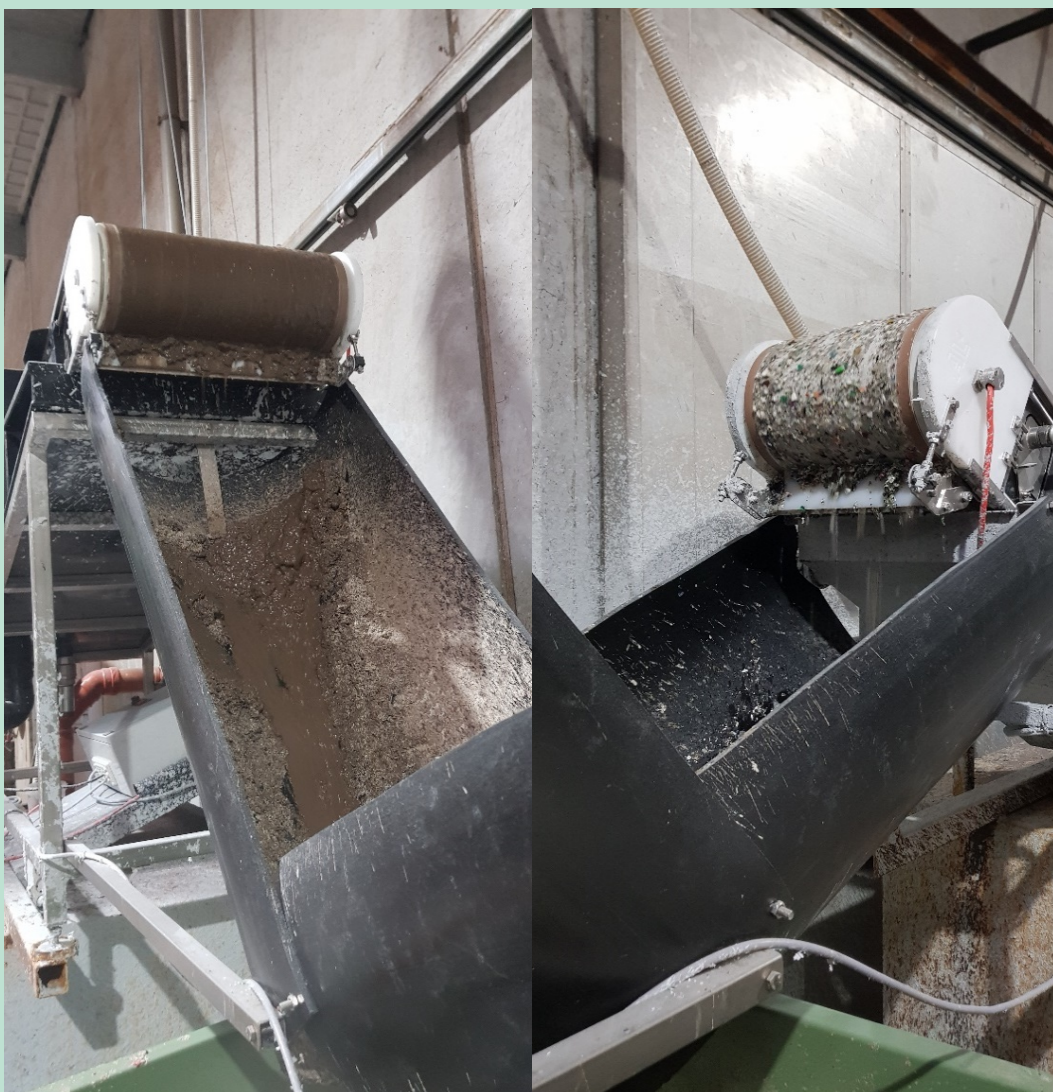
FIGUR 32. Filtrering af slam fra vaskeprocessen (tv). Frafiltrering af væske fra synkefraktion fra densitetssortering (th).
