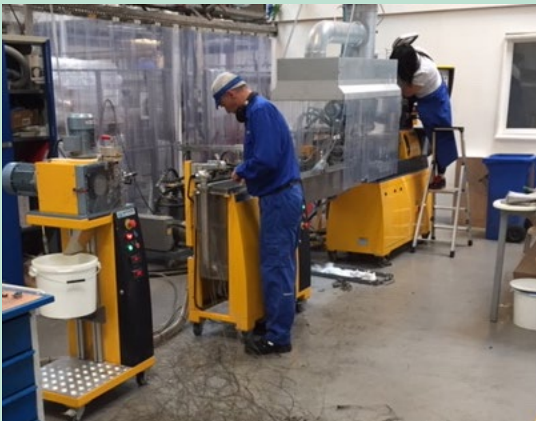
FIGUR 21. Ekstrudering af PET i laboratorieekstruder ved SKY-LIGHT.
