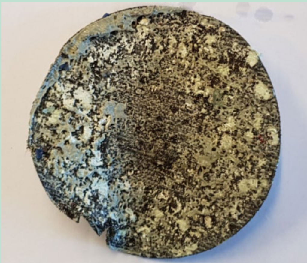
FIGUR 14. Smeltefilter (mesh 14/88) fra ekstrudering af HDPE fra Reno-Nord.
