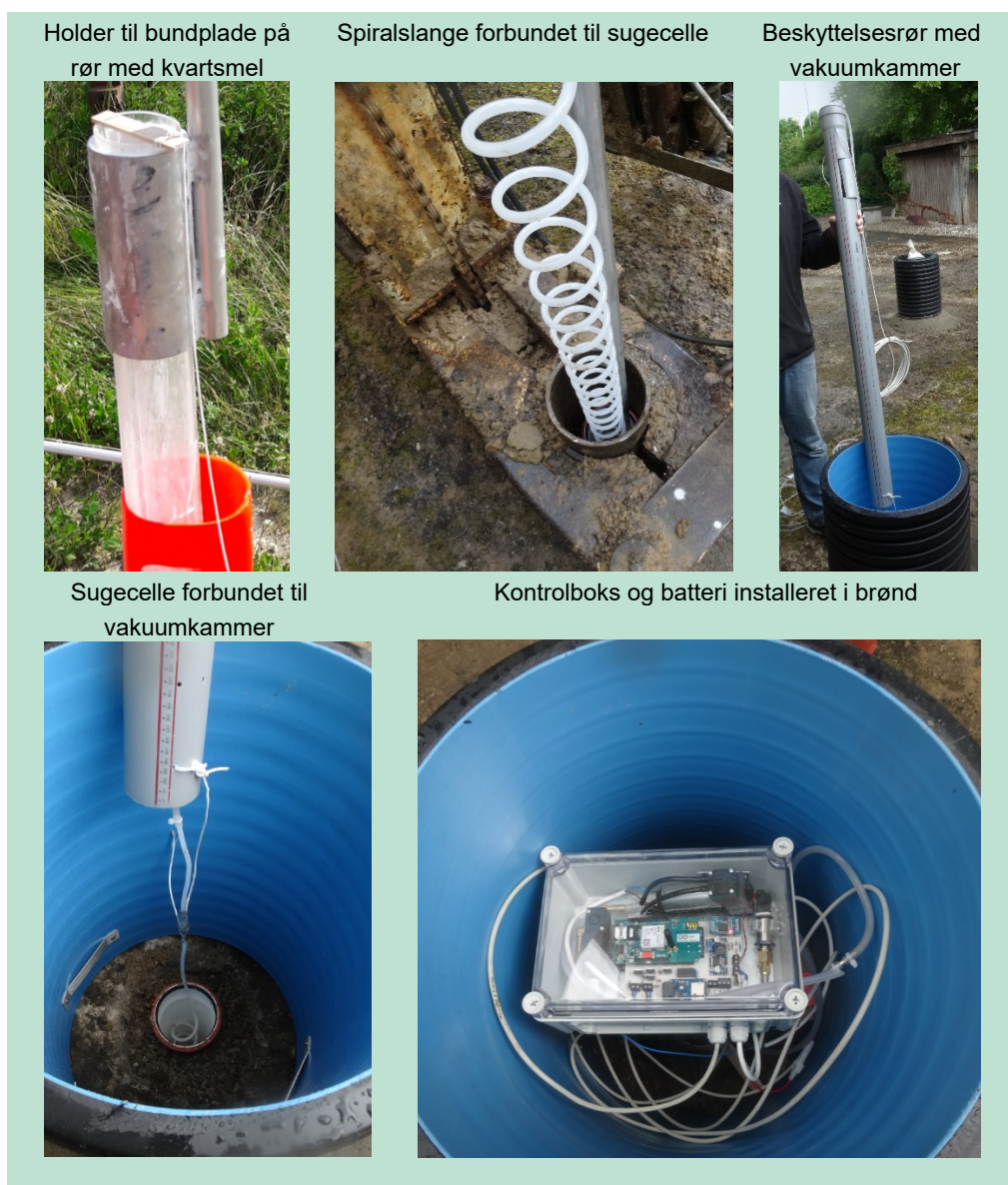
FIGUR 3.6. Fotos fra dyb installation af porevandsprøvetager.
