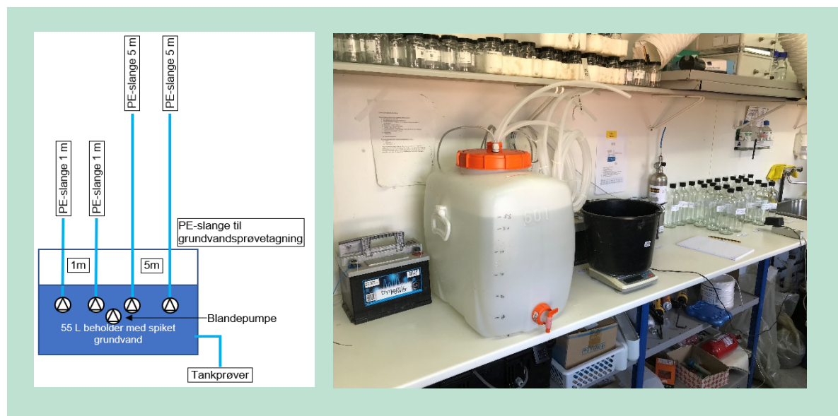
FIGUR 6.4. Forsøgsopstilling til test af massebevarelse i PE-slanger til grundvandsprøvetagning.
