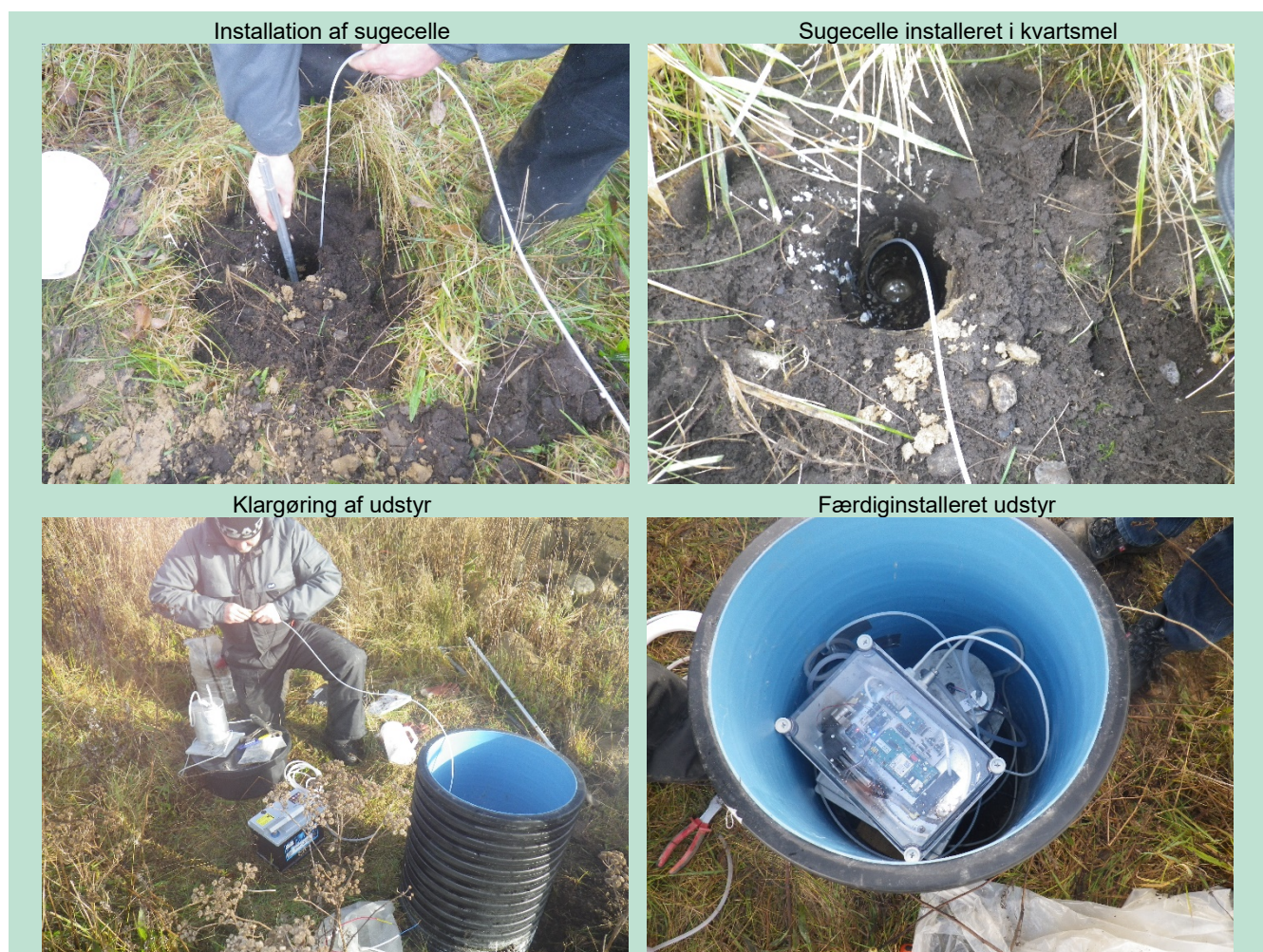
FIGUR 11.5. Fotos fra installation af sugeceller.
