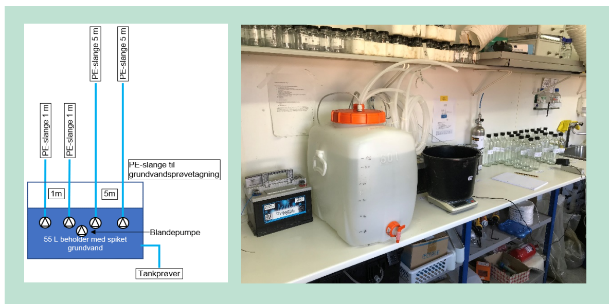
FIGUR 7.1. Forsøgsopstilling til test af massebevarelse i PE-slanger til grundvandsprøvetagning.
