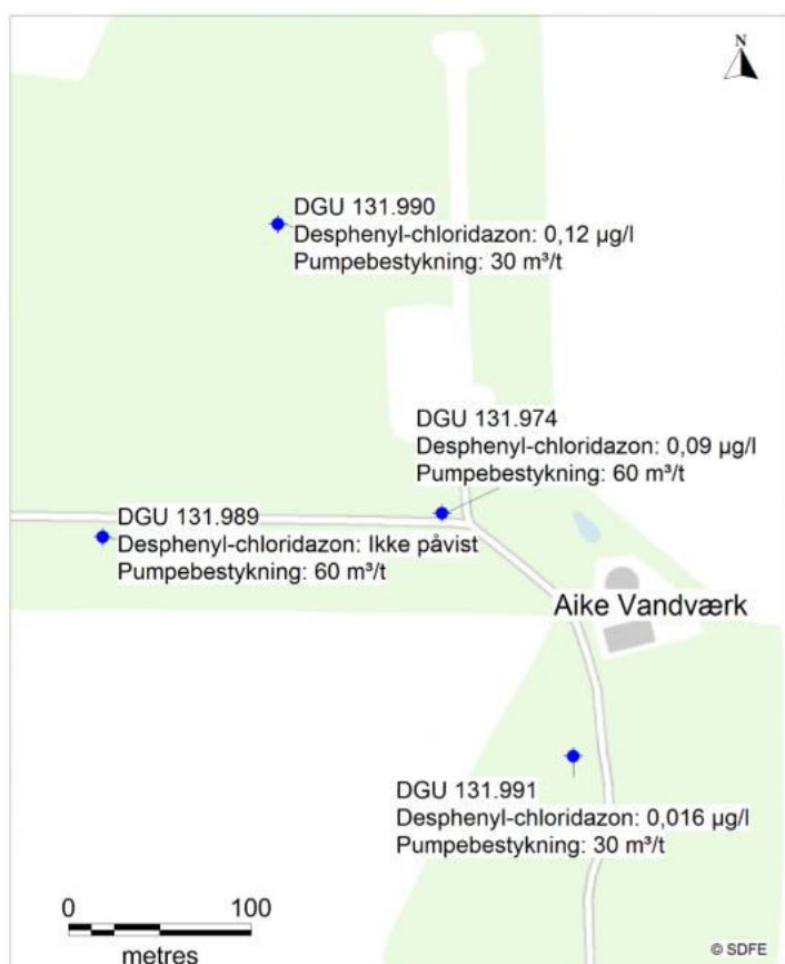
FIGUR A1.4 Indhold af DPC og pumpebestykning i Aike vandværk (Region Syddanmark, 2018)
