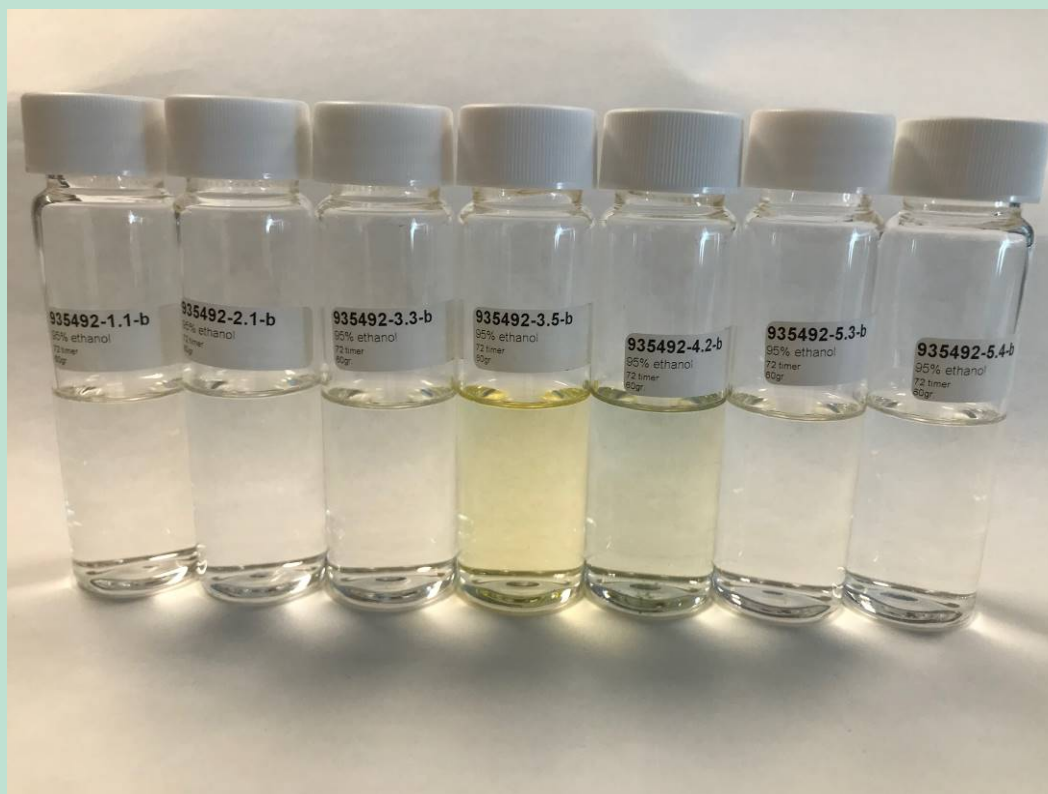
FIGUR 22. Billeder viser migrationsvæsken 95 % ethanol, der er udtaget efter migration. Det kan ses, at nogle prøver har taget farve fra migrationen. Det gælder prøve 3.5 og prøve 4.2. Der observeres ikke uklarhed i prøve 5.3, som det sås ved anvendelse af isooktan.
