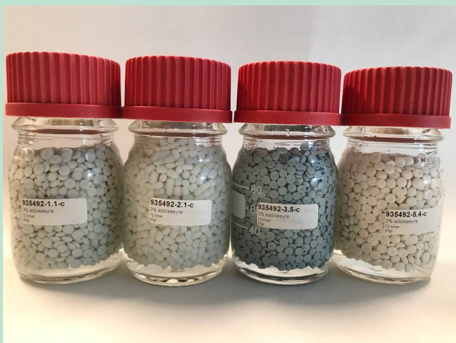
FIGUR 23. Billede af prøver umiddelbart efter migration til 3 % eddikesyre. Der bemærkes ikke nogen forskel i materialet efter migrationen. Bemærk, at materialet flyder ovenpå, da densiteten af denne migrationsvæske overstiger densiteten af prøvematerialet.
