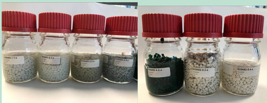
FIGUR 19. Billede af prøver umiddelbart efter migration til isooktan. Fra venstre mod højre ses prøverne nummereret 1.1, 2.1, 3.3, 3.5, 4.2, 5.3 og 5.4. Det ses, at prøve 4.2 og 5.3 har suget migrationsvæske til sig og er kvældet.
