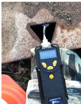
Måling ned i primære brønd
