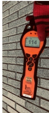
PID måling ca. 0,7 m u.t. ved tidligere påvist hotspot (PL802).
