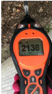
PID måling ca. 0,7 m u.t. ved hundemarkering (PL801).
