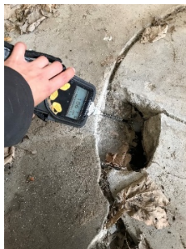
PID måling ved brønddæksel
