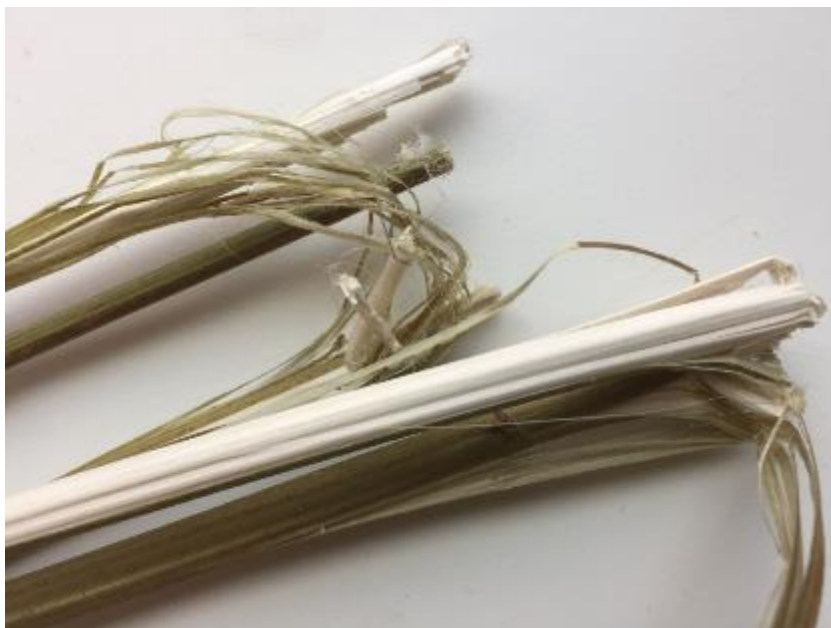
FIGUR 4.3. Hampestrå, med stærke fiberbundter, kaldet taver, yderst og hampeskæven, inderst. Høst 2018.
