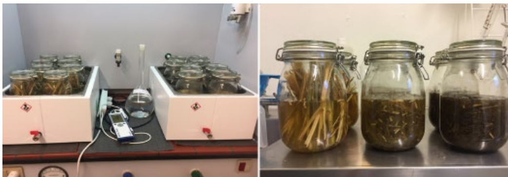
FIGUR 7.3. Opstilling af forsøg med glaskrukker i varmebad til brug ved screening af mange prøver på én gang
