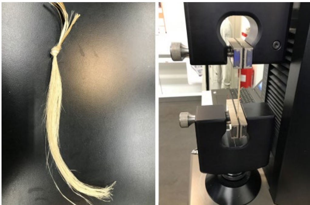
FIGUR 8.28. Måleapparat til bestemmelse af trækstyrke af såvel enkeltfibre som fiberbundter på VIA University College, Herning. Fibrene tv. Er skættet og heglet med den "nye" fin-hegler.
