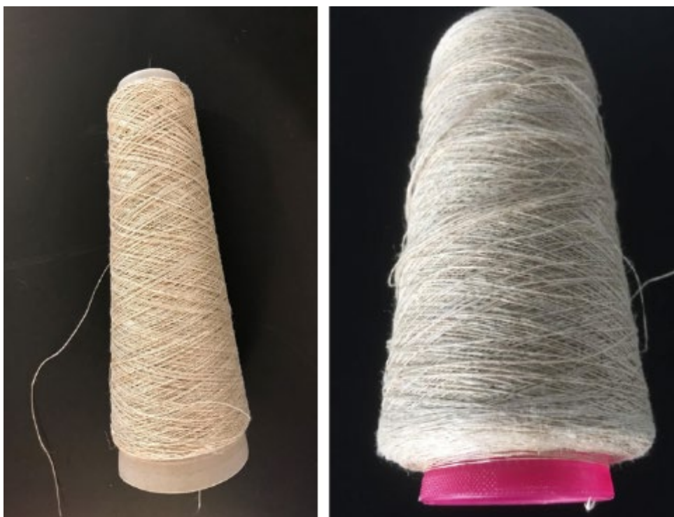
FIGUR 9.2. Hampegarn er typisk mere stift end fx hørgarner. Tv den grovere kvalitet og th den finere garnkvalitet.
