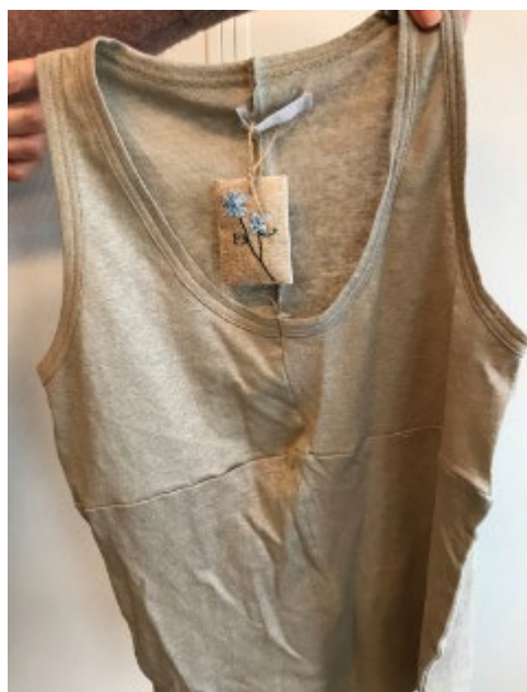
FIGUR 11.3. Prøve T-shirt af hør (fra Rachel Kollerup flagskibs kollektion), som er fremstillet af strikket metervarer er testet. Den er delt op og syet igen efter behandlingerne.
