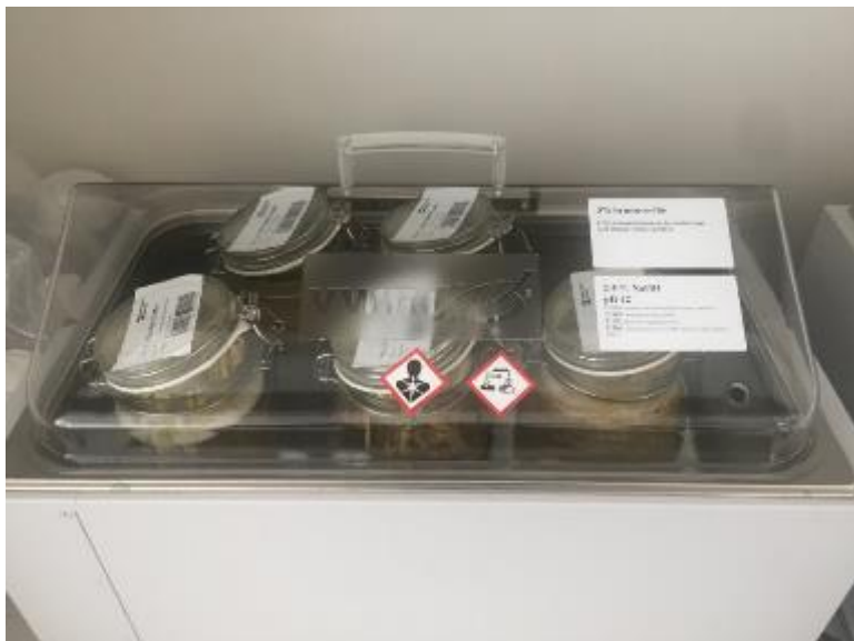
FIGUR 8.14. Forsøgsopstilling med hydrogenperoxid forsøg, med 3 forskellige råvarer fra råvareforsøg 2018. Forsøgene foregår i de termostat-styrede .
