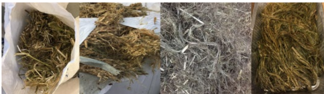
FIGUR 8.10. Forskellige hamperåvarer, til enzymforsøg. Fra venstre mod højre Nr. 1. Futurahamp høst sept. 2017. nr. 2. Ensilaret hamp, Futura, høst 2016. Nr. 3. Vinterrødnet Futura-hamp, høst april 2017. Nr. 4. Kina-hamp, lange urødnede fibre, importeret 2017-
