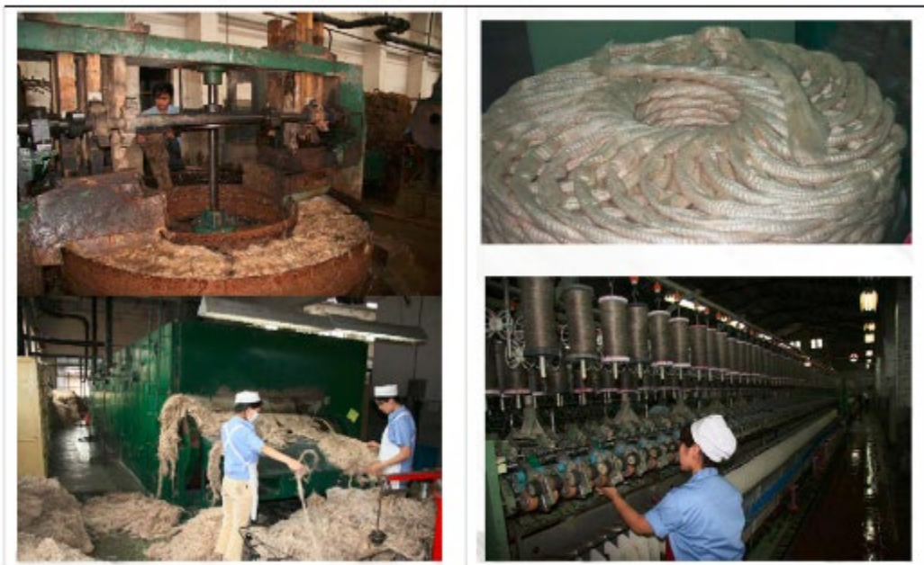
FIGUR 4.10. Fremstilling af hampefibre til spinning – i 3.verden, her Kina 11 .
