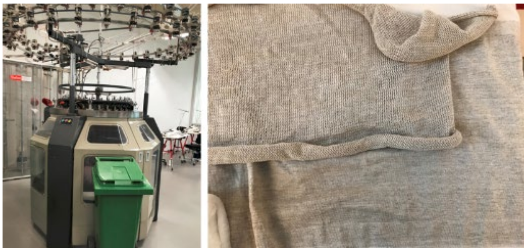
FIGUR 9.4. Tv: Rundstrikkemaskine ved VIA University College, Herning, hvor vi kørte nogle af forsøgene. Th rundstrikkede hampemetervarer.
