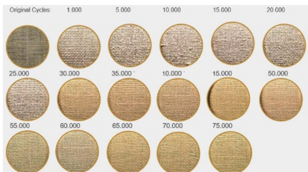
FIGUR 12.4. Slidstyrketest (Martindale) og pilling. Panama-vævet hampetekstil. Problem med pilling overstås efter 25.000 rubs, og udseendet holder helt op til 75.000 rubs, førend kvaliteten er skadet.
