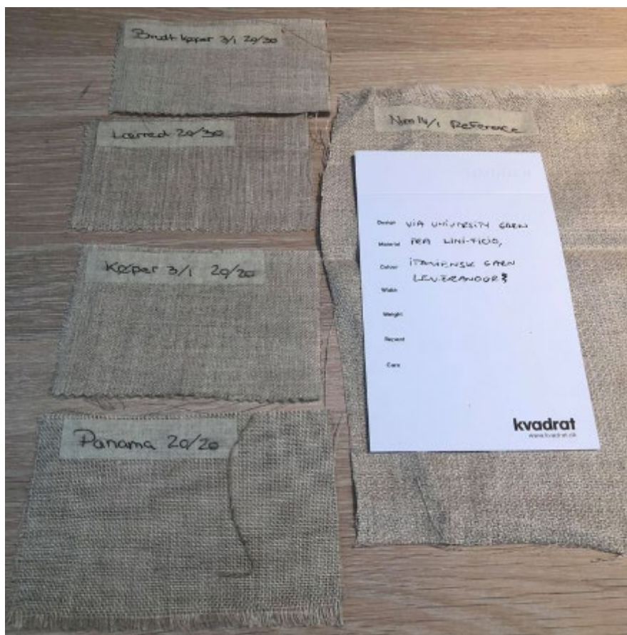
FIGUR 12.7. Test af de forskellige vævede typer af hampemetervare fra VIA University College, Herning.
