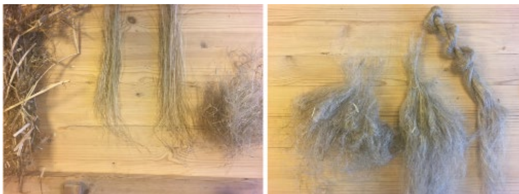
FIGUR 9.1. Tv: Rødgede hampefibre, høst 2017, som er heglet og kartet. Th tilsvarende rødgede hørfibre, som er finere end hampefibrene.
