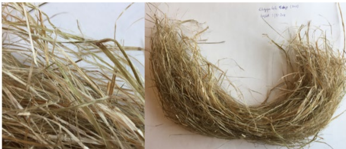
FIGUR 7.12. Grovheglede enzymbehandlede hampefibre. Her kun heglet med den grove hegler og med tydelige bundter af fibre. Høst 2017.
