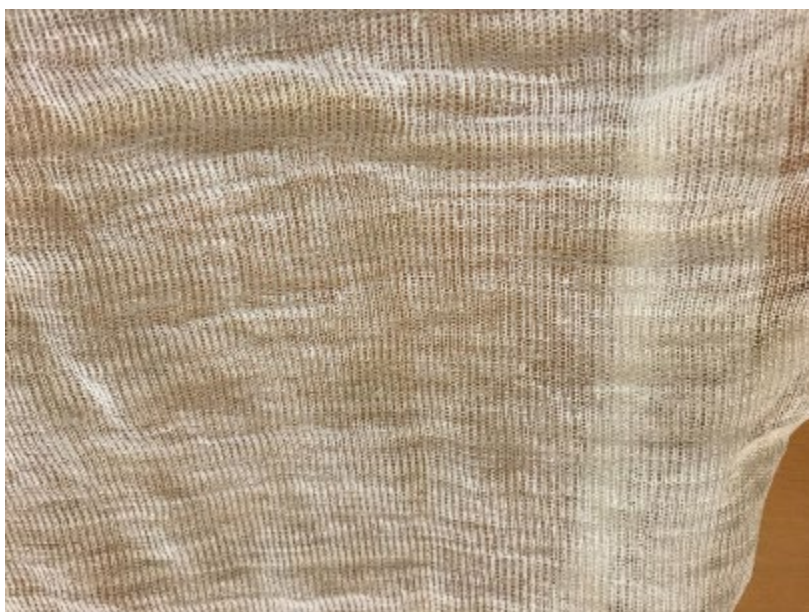
FIGUR 9.5. Strikkede hampemetervare, til fx T-shirts. Der er en uensartethed, og steder, hvor strikken er tyndere, og hvor tråden lettere kan knække.
