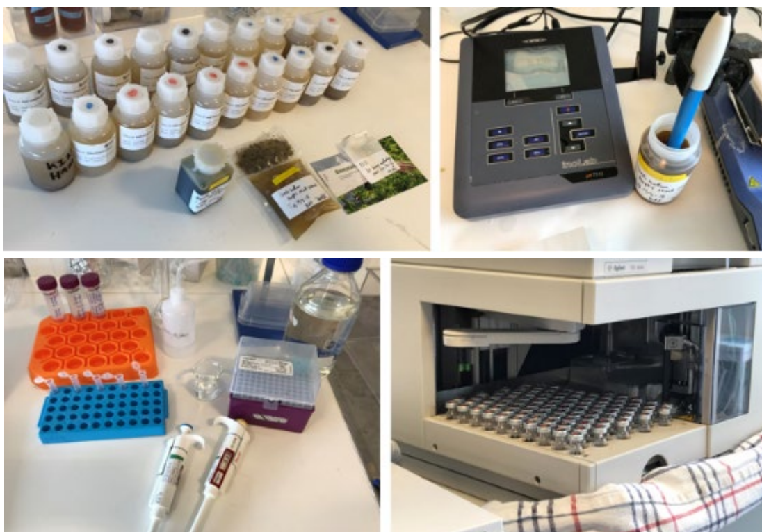
FIGUR 7.11. Forsøgssopstilling til HPLC-analyse, som gennemføres på Teknologisk institut i Høje Tåstrup.
