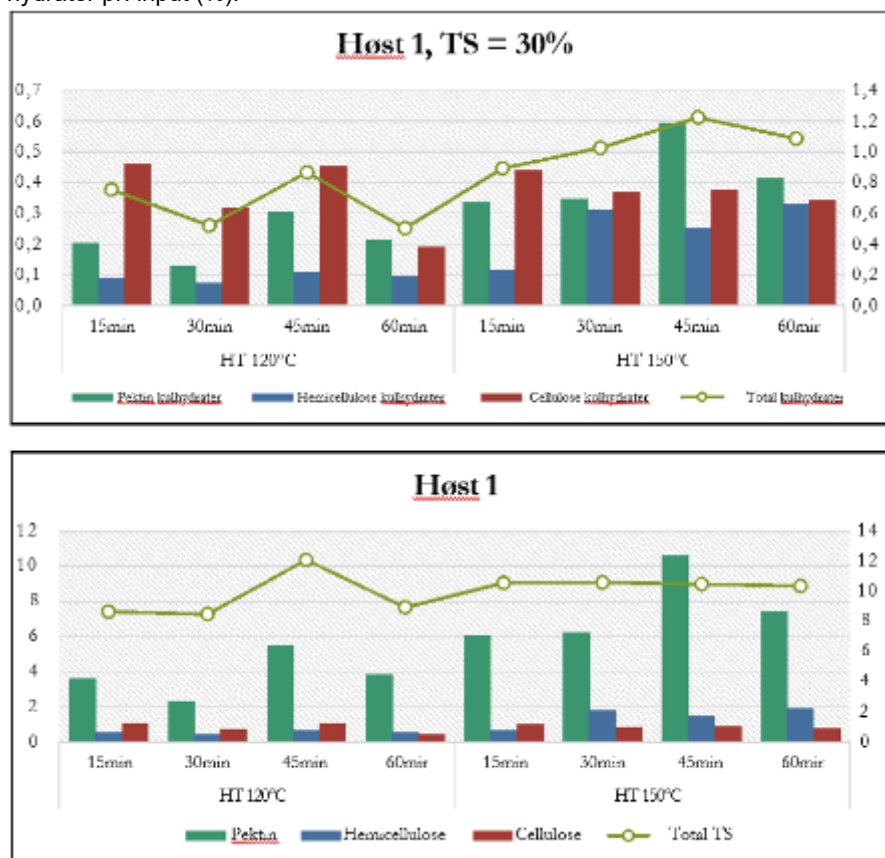
FIGUR 8.19. HPLC-analyse. Høstforsøg. Høst 1, HT-behandling ved 120°C mod 150°C, TS = 30%. Øverst er de beregnede opløste kulhydrater (g / 100 g TS). Nederst udbyttet i %.
