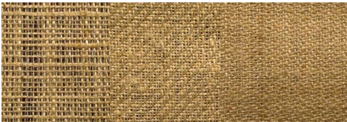
FIGUR 5.2. Eksempler på forskellige typer af vævninger med hampegarn af varierende tykkelse (finhed), fra venstre: lærredsbinding, Twill Køperbinding, Twill/brudt køperbinding, Fra forsøg på VIA University College, Herning.
