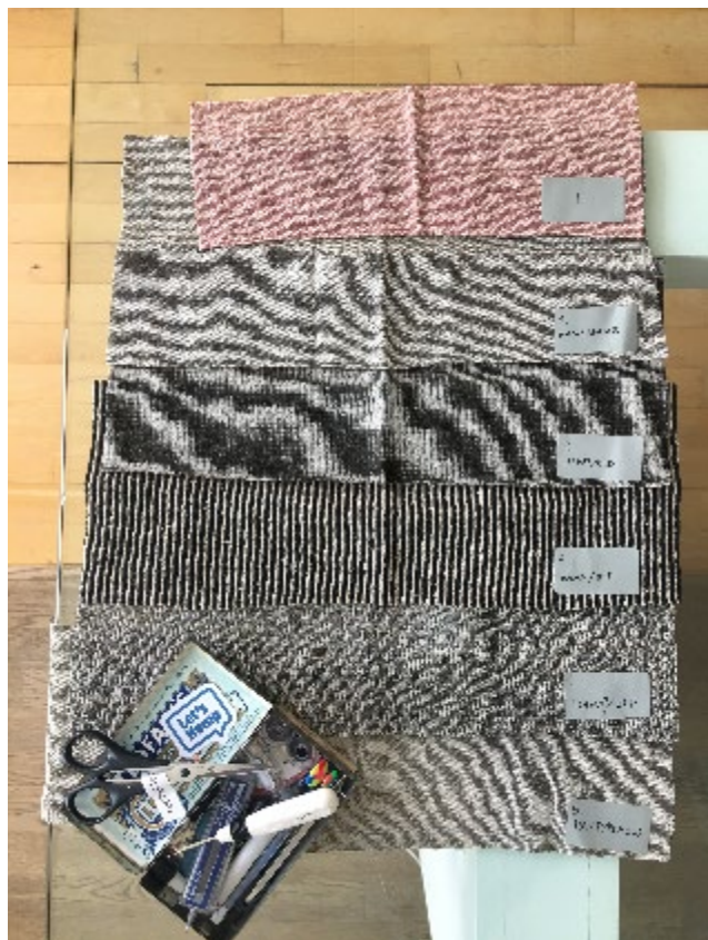
FIGUR 9.3. Strikkede metervarer fremstillet i projektet består af blandinger med hamp, silke, uld og bomuld. Der ved overvindes udfordringen med rene hampefibre til strik.
