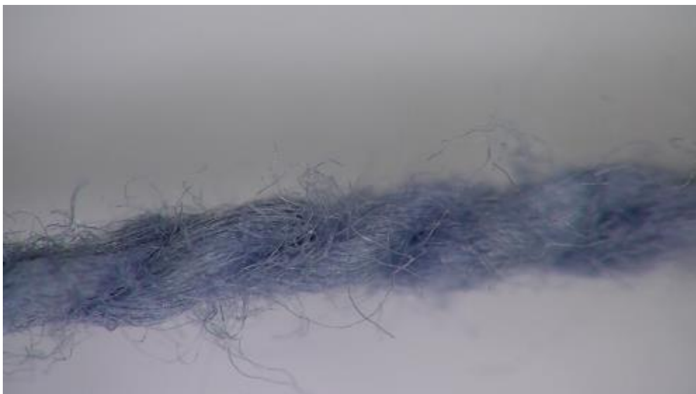
FIGUR 5.1. Cottoniserede hampefibre, spundet af korte hampefibre.
