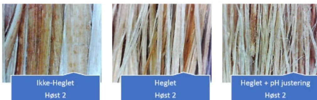
FIGUR 8.23. Mikroskopering af HT-behandlede hampefibre, fra råvare 2018, høst 2. Taverne er heglet.
