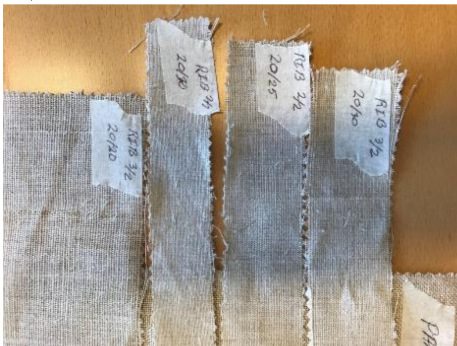
FIGUR 9.6. Forskellig vævede kvaliteter af hampetekstiler, vævet på VIA University College, baseret på hampgarn fra Linificio.
