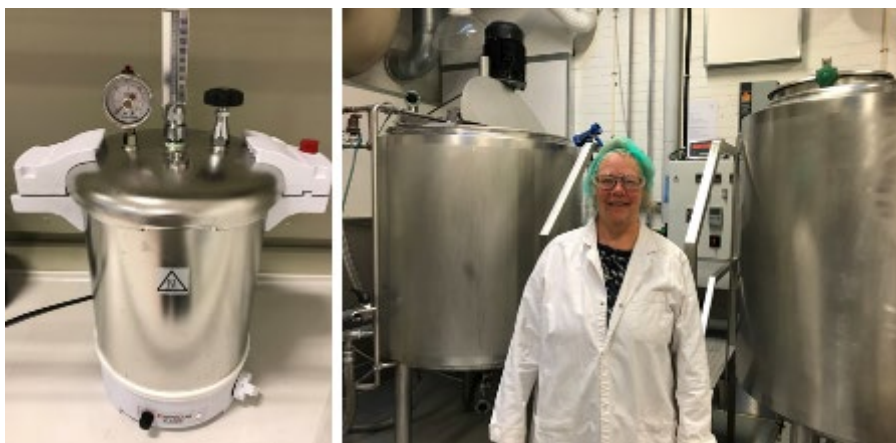
FIGUR 7.6. Tv. Trykkoger til lab-forsøg med HT-behandling. Th. Bioraffineringsanlægget hos TI, afd. for Bioresourcer og bioraffinering.
