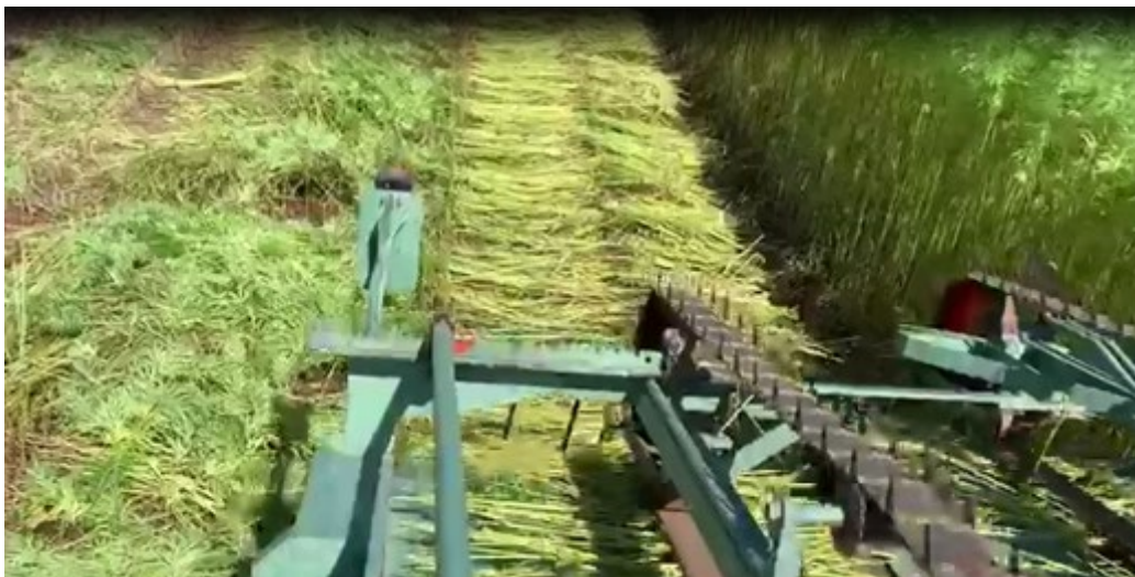
FIGUR 6.6. Klar til første prøvekørsel af hampetekstilhøsteren, aug. 2020. Toppen er afskåret og stænglerne ligger parallelt.
