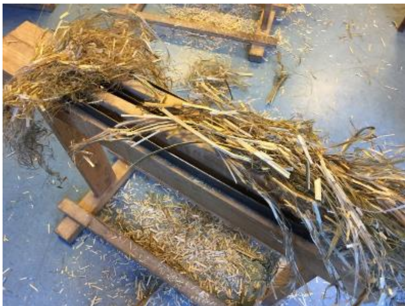
FIGUR 7.13. De grove hampestængler føres først gennem en bryder (her hørbryder ved Den Grønne Museum), til at knække skæverne inden den videre skætning vha. en hegler.
