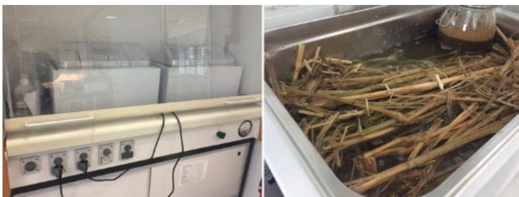
FIGUR 7.4. Opstilling af forsøg ved screening af større prøve på én gang (ca. op til ½ kg råvare)
