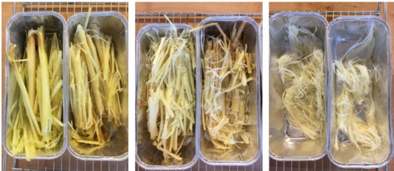
FIGUR 8.15. Blegforsøg med hydrogenperoxid. Tv. Ubehandlede hampestrå, i midten: enzymbehandlede strå og th heglede enzymbehandlede hampefibre.
