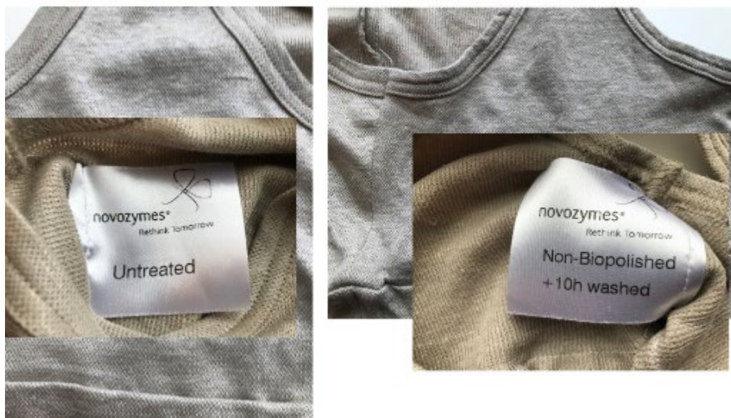
FIGUR 11.4. Tv, øverst: kontrol, ingen bio-polishing. Th: x 10 vaske, ingen bio-polishing.
