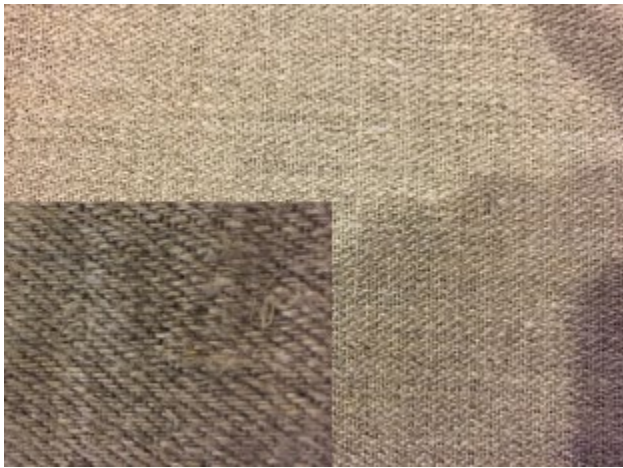
FIGUR 9.11. Nærbillede af meget groft vævet hamp fra Frankrig, dog en anden leverandør, som er meget løst vævet og mindre egnet til beklædning.
