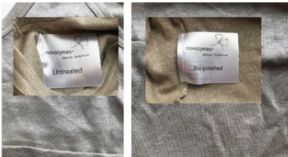
FIGUR 11.6. Tv, Ingen bio-polishing (control).. Th, Med bio-polishing
