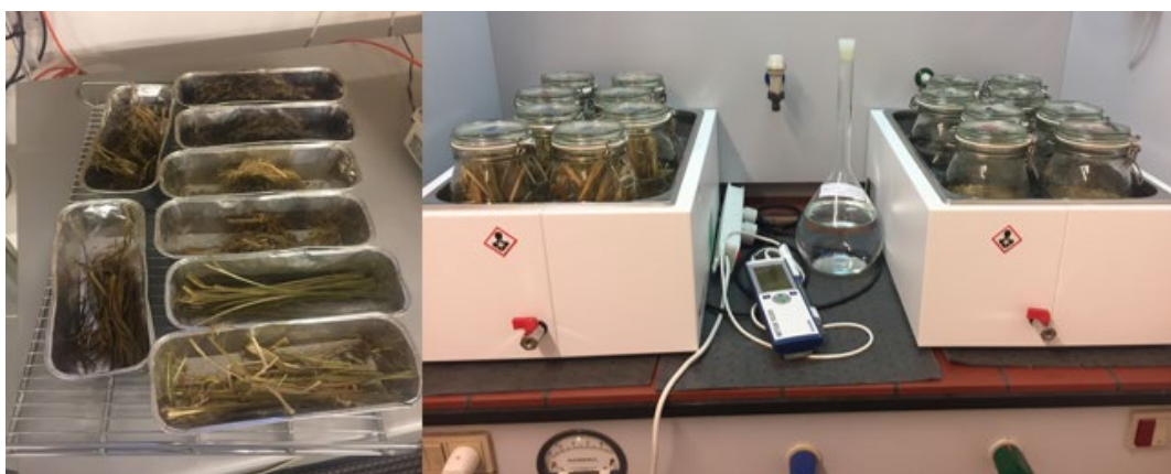
FIGUR 8.7. Screening af forskellige råvarekvaliteter med enzymrødning. Stænglerne er afkortet til 15 cm længde, passende til forsøg i de små forsøgsglas.
