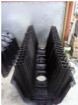
Tunnel og netblokrækker vist omvendt af endelig montering. Foto: Peder S. Gregersen
