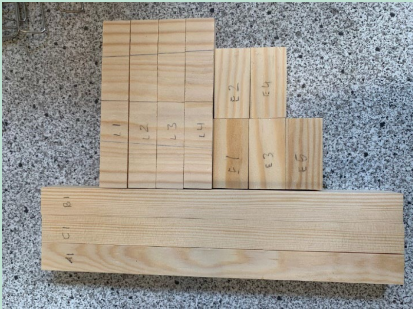
FIGUR 6. Sæt af prøveemner til superkritisk imprægnering.
