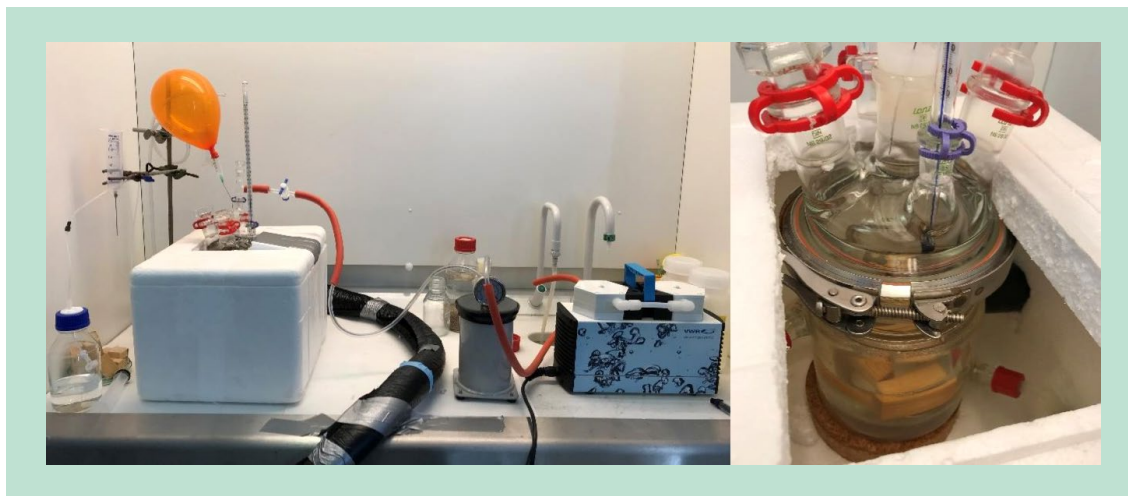
FIGUR 2. Forsøgsopsætning til imprægnering af træklodser.
