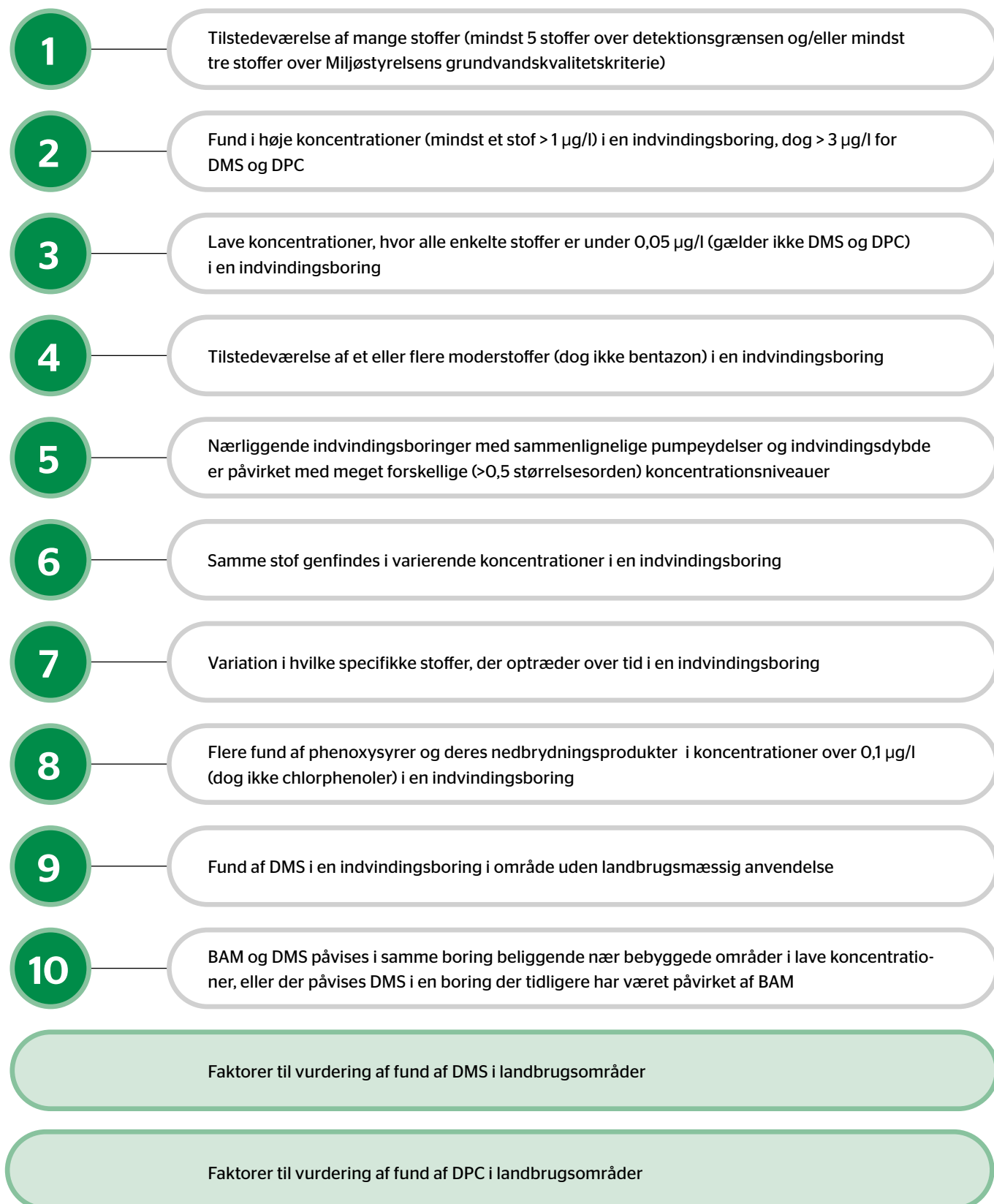
Figur 3: Indikatorer til vurdering af, hvorvidt fund i en indvindingsboring kan henføres til en punktkilde og/eller fladekilde
