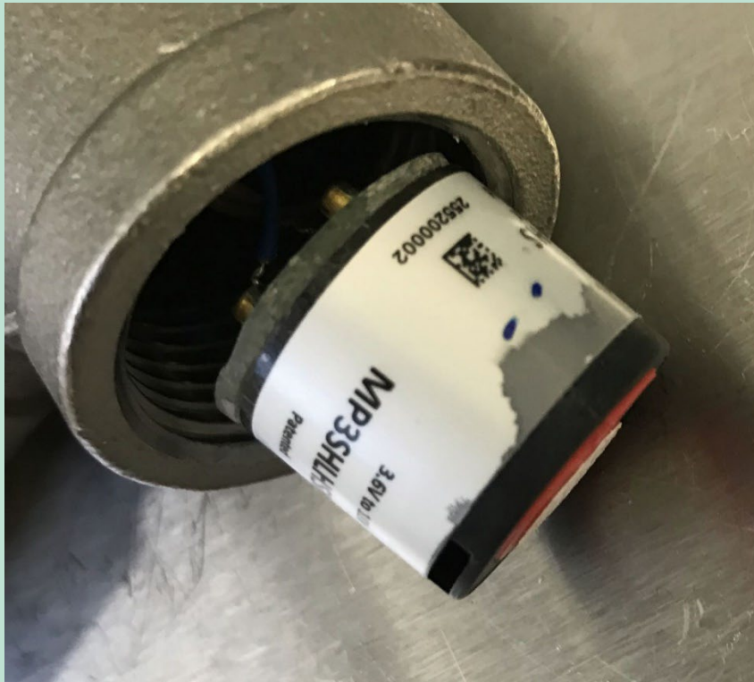
FIGUR 16. Sensoren efter flere ugers drift viser tegn på nedbrydning af klistermærket omkring sensoren, hvilket ses ved, at det hvide materiale tilsyneladende er nedbrudt (vel at mærke på den side af mærket, som vender ind imod sensoren).
