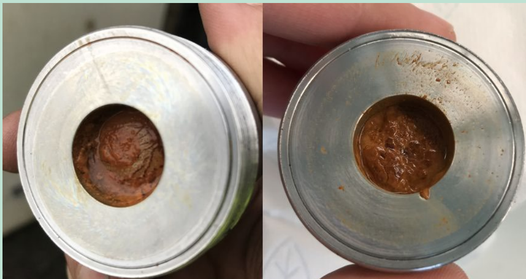
FIGUR 10. Tilstopninger af membranen, hver efter ca. 14 dages test.
