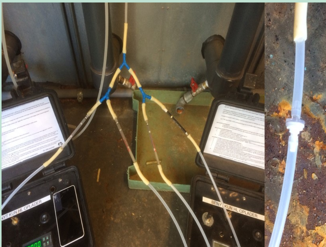
FIGUR 6. Prøvetagning af poreluft ved lave koncentrationer. Til højre ses kontraventil som bør placeres mellem kulrør og pumpe.
