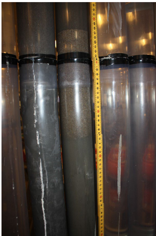
Fig 2.3.6 Rør 2.3.7 (med målestok) Groft sand (Dansand 2) direkte over grout (G2)
