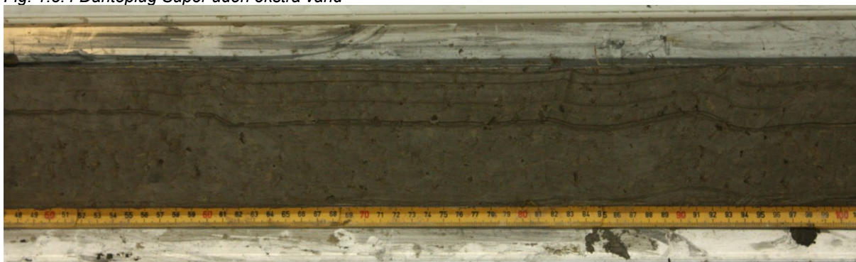
Fig. 1.5.5 Dantoplug Super med ekstra vand. Furerne i overfladen skyldes opskæringsværktøjet
