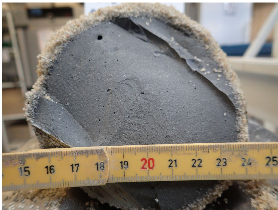
Fig. 1.4.13 Rør 7. Ren cement
