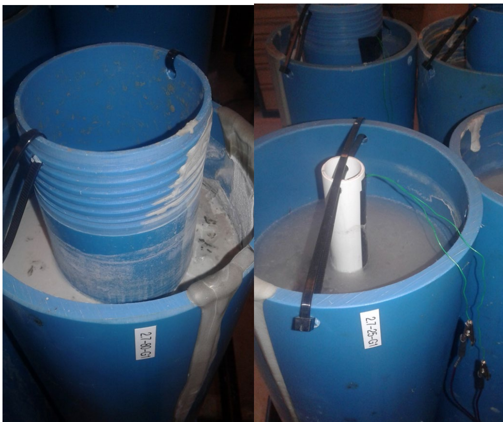
Fig. 2.7.1 Rør med 35 mm annulus (venstre) henholdsvis 60 mm annulus (højre)
