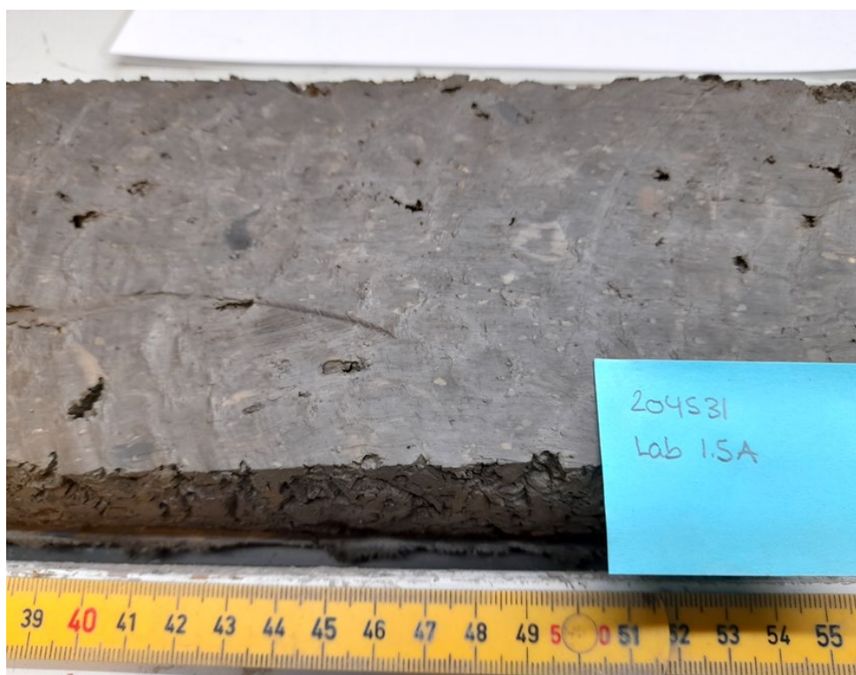
Fig. 1.4.19 Rør A. Nærbillede af pelletsforsegling opkvældet ved gennemstrømning. Prøven virker homogen. Pellets fylder røret ud og kan ikke skelnes fra hinanden. Der forekommer tydelige porerum der udgør ca. 2% af prøven. Porerne er ikke forbundne og måler ca 2mm X 2-10mm
