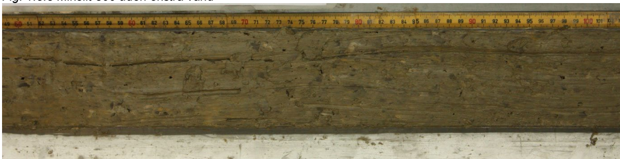
Fig. 1.5.9 Mikolit 300 med ekstra vand. Furerne i overfladen skyldes opskæringsværktøjet
