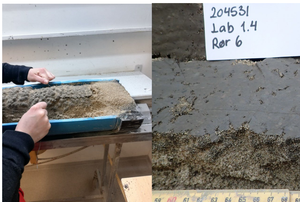
Fig. 1.4.12 Rør 6. Dantoplug Super. Umættet zone uden startvandmætning. Forsegling flækkes med osteklinge. Nærbillede af forsegling
