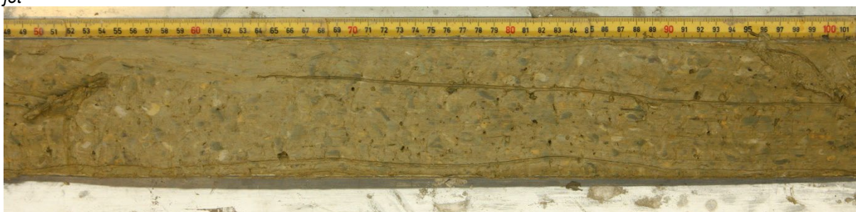
Fig. 1.5.6 Mikolit B uden ekstra vand. Furerne i overfladen skyldes opskæringsværktøjet
