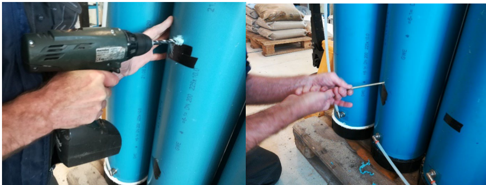
Fig. 1.4.3 Udtagning af prøver til vandindholdsbestemmelse. Først bores hul i pvc-røret, derefter udtages prøve af forseglingsen med en sonde
