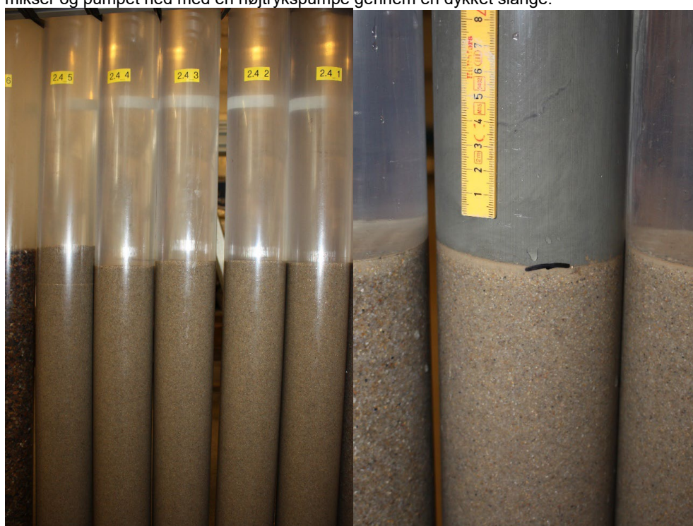
Fig. 2.3.7 Til venstre: Rør 2.4.1 til 2.4.5 Mellemkornet sand (Dansand 00) fyldt i bunden af rørene. Til højre: Rør 2.4.1 Grout (G1) direkte over mellemkornet sand
