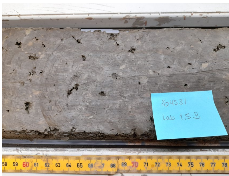
Fig. 1.4.20 Rør B. Nærbillede af pelletsforsegling opkvældet ved gennemstrømning. Prøven virker homogen. Pillerne fylder røret ud og kan ikke skelnes fra hinanden. Der forekommer tydelige porerum der udgør ca. 2% af prøven. Porerummene er ikke forbundne og måler ca 1-5mm X 2-10mm
