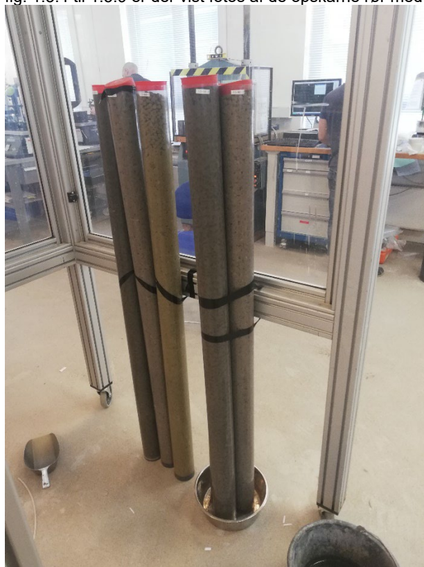
Fig. 1.5.1 Tre pelletsfyldte rør lukket i begge ender og tre rør med "tåen" i vand for mulig op-sugning af yderligere vand
