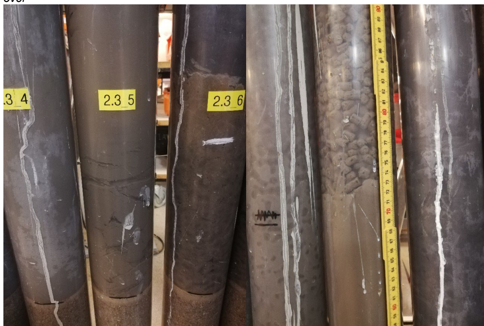
Fig. 2.3.4 Til venstre: Rør 2.3.4 og 2.3.5 Grout 4 og 5 direkte på groft sand. Grout 5 er blevet for tykflydende og har efterladt huller i forseglingen. Til højre: Rør 2.3.5 (i midten med målestok) Grout-pellets overgang
