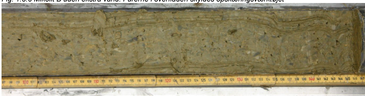
Fig. 1.5.7 Mikolit B med ekstra vand. Furerne i overfladen skyldes opskæringsværktøjet
