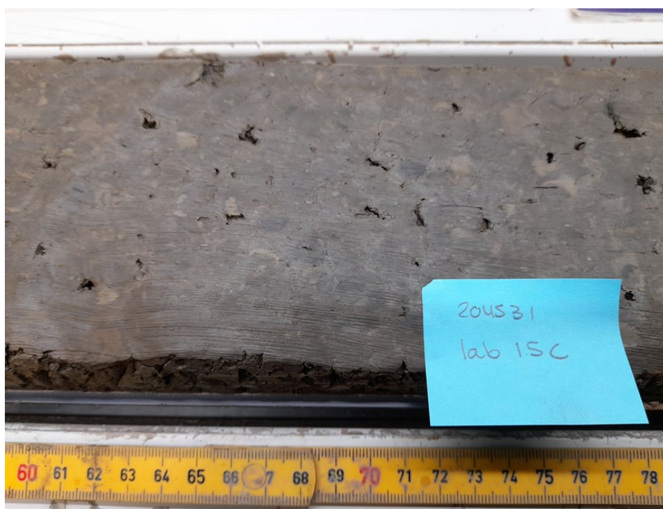
Fig. 1.4.21 Rør C. Nærbillede af pelletsforsegling opkvældet ved gennemstrømning. Prøven virker homogen. Pillerne fylder røret ud og kan ikke skelnes fra hinanden. Der forekommer tydelige porerum der udgør ca. 2% af prøven. Porerummene er ikke forbundne og måler ca 1-5mm X 2-10mm
