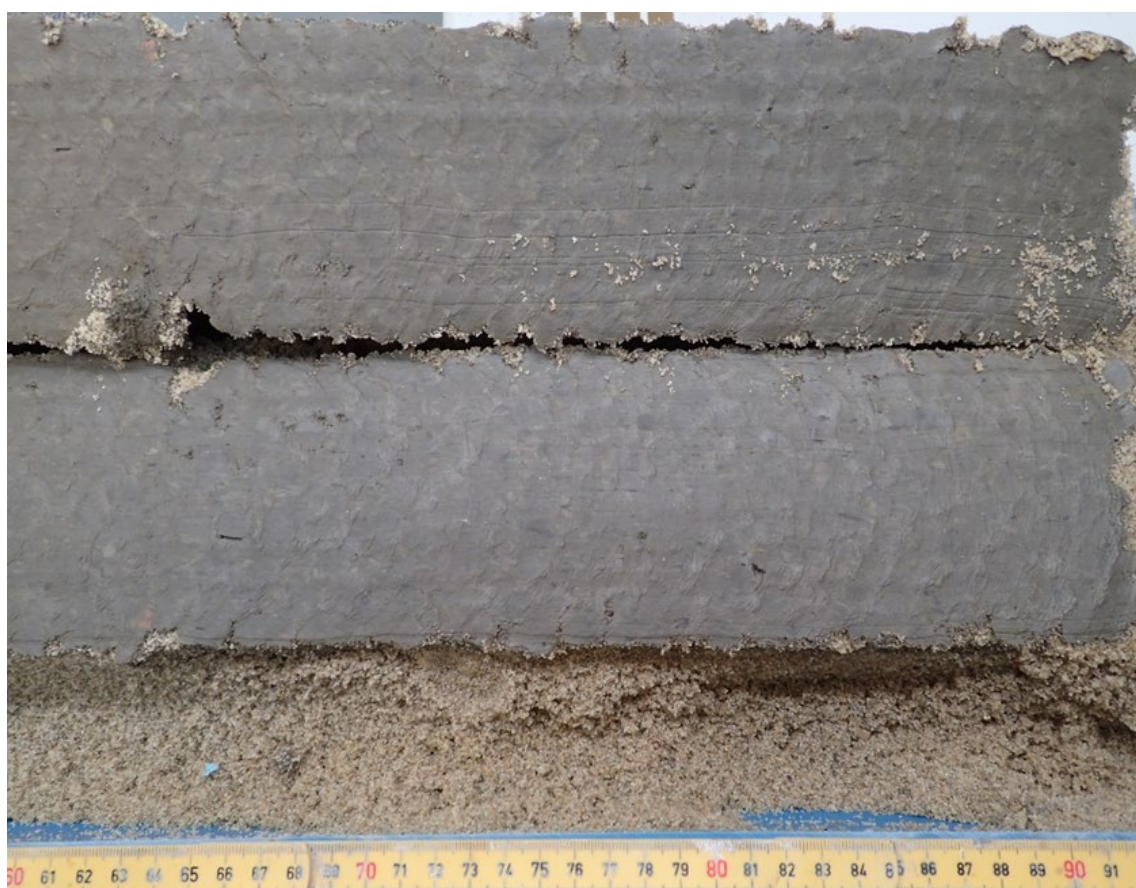
Fig. 1.4.9 Rør 2. Dantoplug Super efter opskæring. Regn. Homogen struktur
