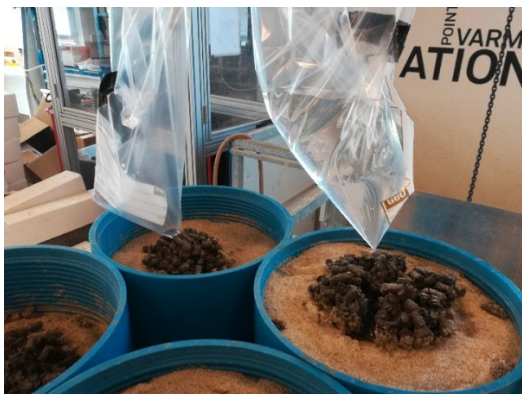
Fig. 1.4.2 "Regnvej". 750ml vand dryppes over prøven en gang om ugen
