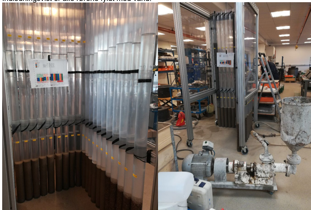
Fig. 2.3.1 Til venstre: Alle 20 forsøgsrør fyldt med vand og 0,5 m sand af forskellig kornstørrelse. Til højre: Groutpumpe
