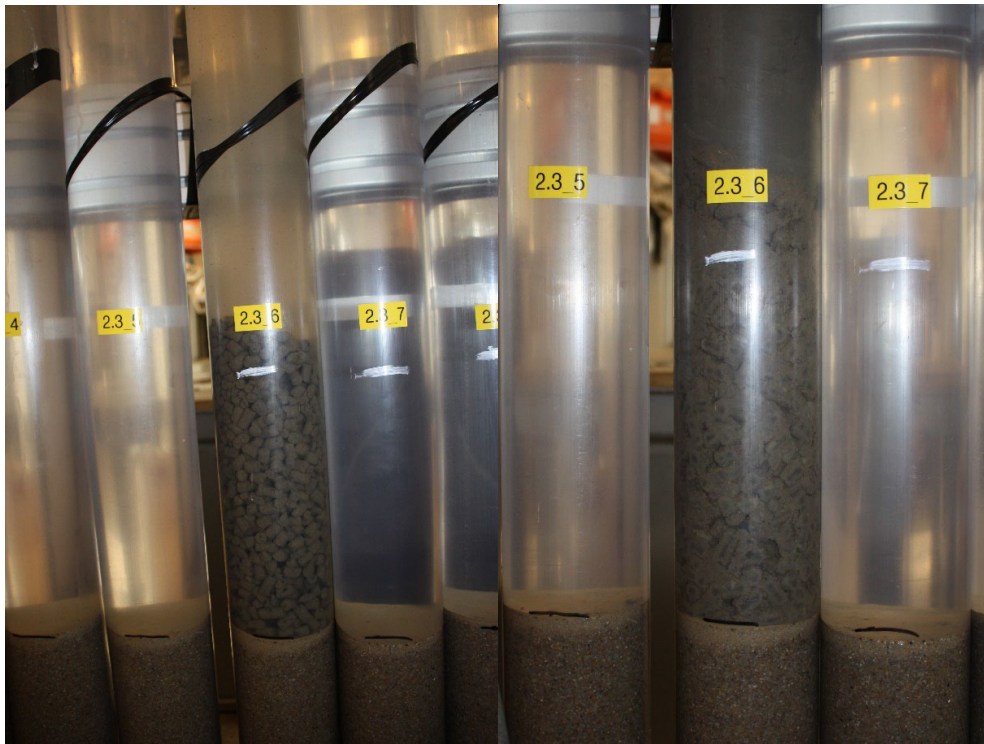
2.3.5 Rør 2.3.6 Til venstre: Pellets direkte på groft sand. Til højre: Grout (G1) direkte på pellets
