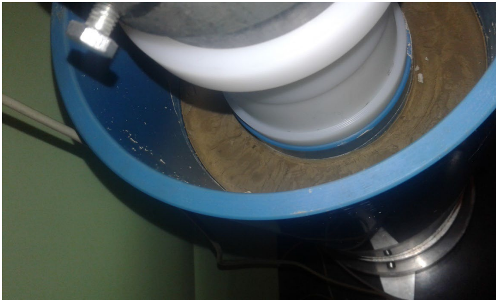
Fig. 2.6.2 Trykforsøg på PVC rør i grout med 80 % bentonit (G5)
