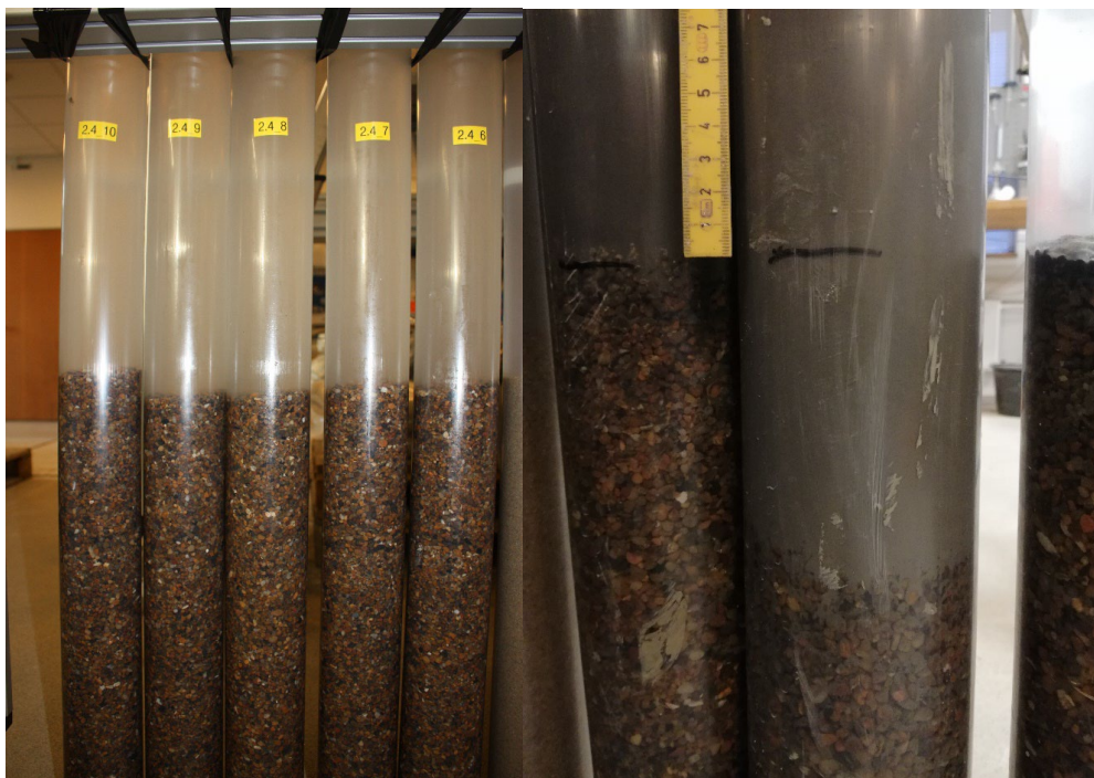
Fig. 2.3.8 Til venstre: Rør 2.4.1 til 2.4.5 Grus (Dansand 7) fyldt i bunden af rørene. Til højre: Rør 2.4.6 og 2.4.7 Grout (G1 og G2) direkte over grus. G1 har ikke blandet sig med gruset, mens G2 er trængt ca. 10cm ned i gruset
