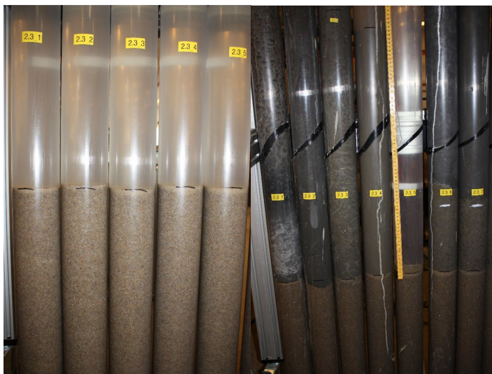
Fig. 2.3.3 Rør 2.3.1 – 2.3.5. Groft sand (Dansand 2) i bunden og grout type 1-5 direkte oven over
