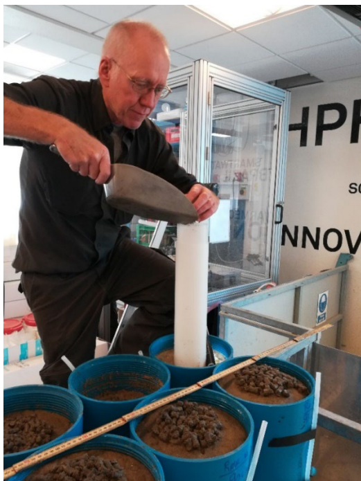
Fig. 1.4.1 Installering af pelletsforsegling ved hjælp af et Ø90 mm peh-rør i fugtigt sand
