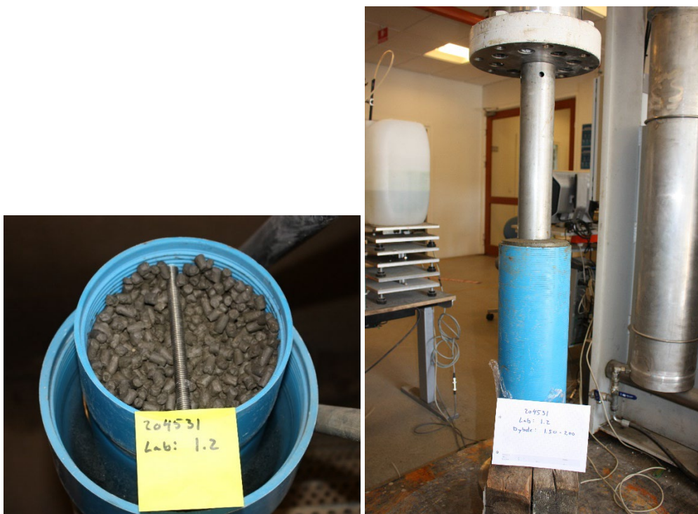
Fig. 1.1.1 Indbygningen af pellet i et Ø165 mm filterrør og nedpresning af A-rør for udtagning af intakt prøve
