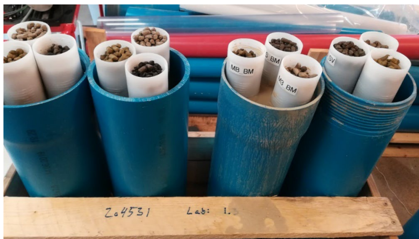
Fig 1.3.1 Fire rør fyldt med hver sin vandtype og hvert rør indeholder tre filterrør med hver sin pelletstype
