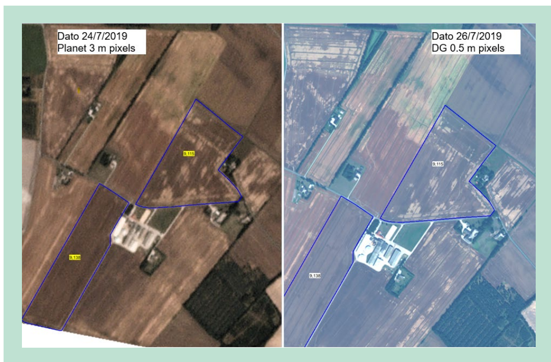
FIGUR 4. Billedet viser samme marker optaget med to forskellige satellitter med en opløsning på henholdsvis 3 meter og 0,5 meter. I dette tilfælde er der fokus på lejesæd, som tydeligt fremgår af billedet til højre.
