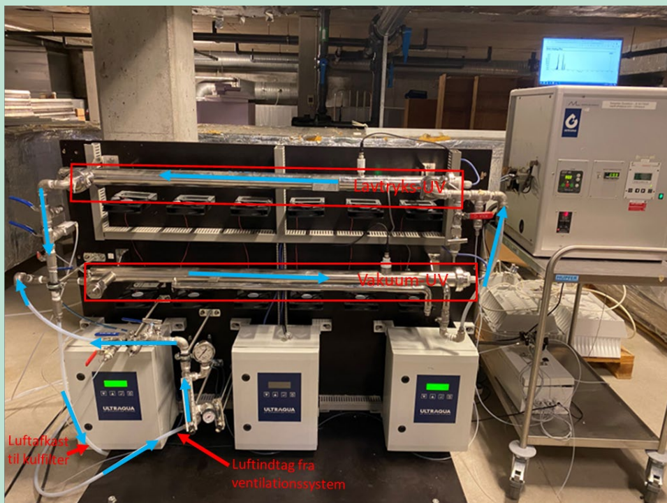
FIGUR 24. UV-system til nedbrydning af kloroform og trikloramin i svømmebadsluft.
