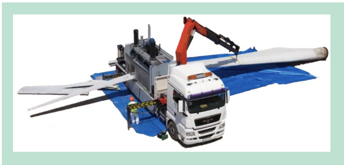
FIGUR 15. Klippeværktøjet til opskæring af vindmøllevinger af spanske Reciclaia Composites Kilde: Ricard, Internetsøgning (2022).
