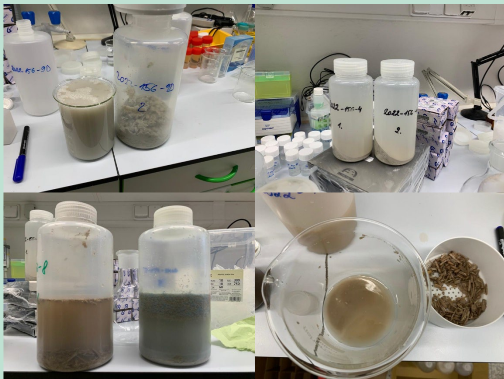
FIGUR 3.5. Batchudvaskningstest i henhold til DS/EN 12457-2 (-4).
