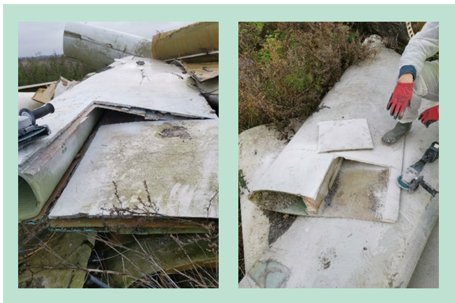
FIGUR 3.1. Udsavning af prøver af vindmøllevingeprofiler på Gerringe Miljøcenter.
