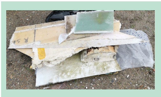
FIGUR 3.2. Prøver udtaget fra vindmøllevinger på Gerringe Miljøcenter.
