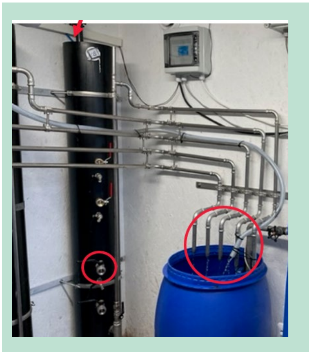
FIGUR 15. Overblik over prøvetagningssteder under pilotskalaforsøget. Den røde pil indikerer indløb til kolonnen. Den røde cirkel på kolonne indikerer den midterste prøvetagning og en røde cirkel ved den blå tønde indikerer udløbsprøvetagningerne.
