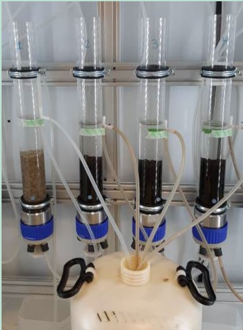
FIGUR 8. Kolonner i køleskab ved 10°C. Første kolonne til venstre indeholder rent sand uden naturligt forekommende bakterier, og de tre efterfølgende kolonner indeholder sand med naturligt forekommende bakterier. Igennem kolonnerne sendes hanevand tilsat 0,5 mg/L \text{NH}_4 for at efterligne forholdene ved et sandfilter på et vandværk.
