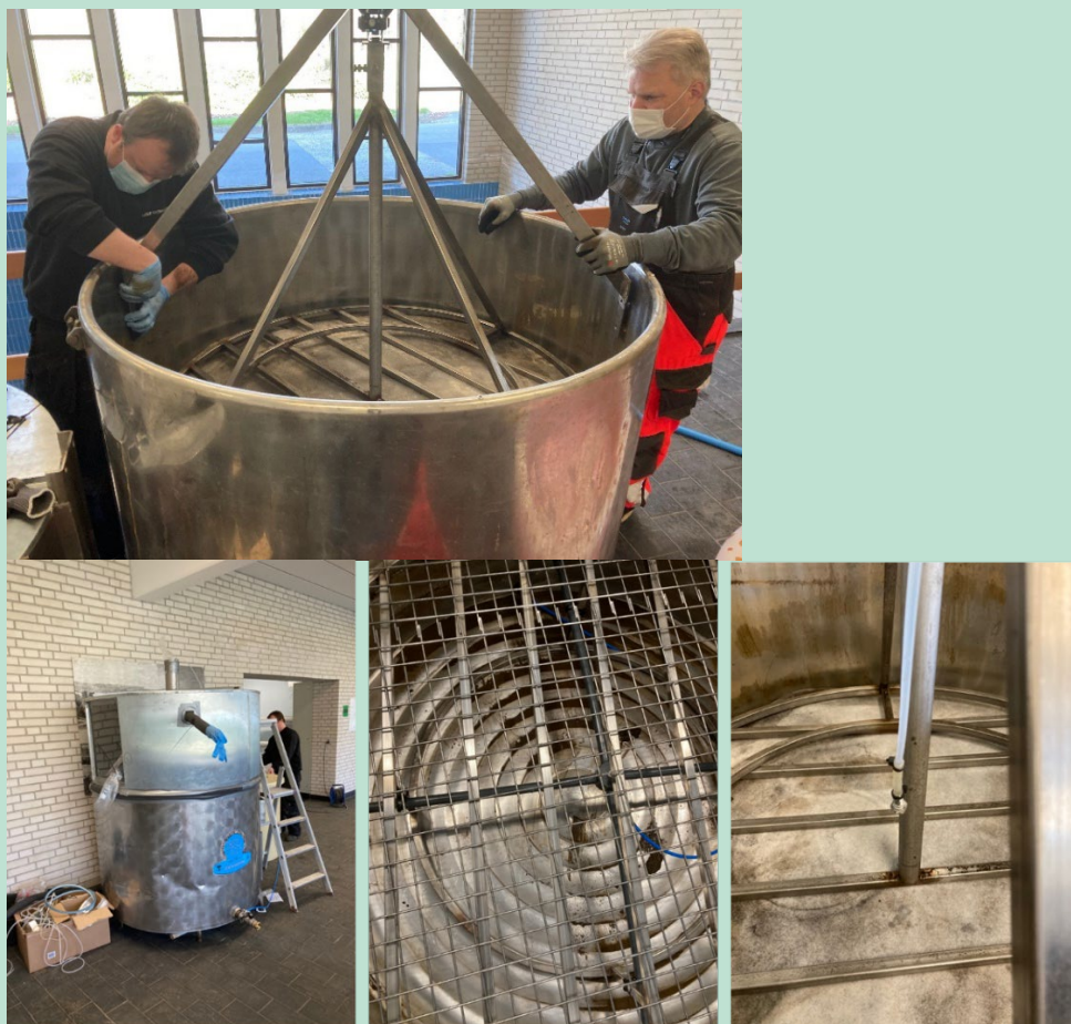
FIGUR 26. Opsætning af forsøg med BioBox'en i fuldskala på Højballegård i Horsens. BioBox'en havde undergået små justeringer ift. Hillerød såsom ekstra metalnet i bunden og et doseringssystem til sporstoffer med konstante mikrodråber, der sprøjtes over skumoverfladen i toppen.
