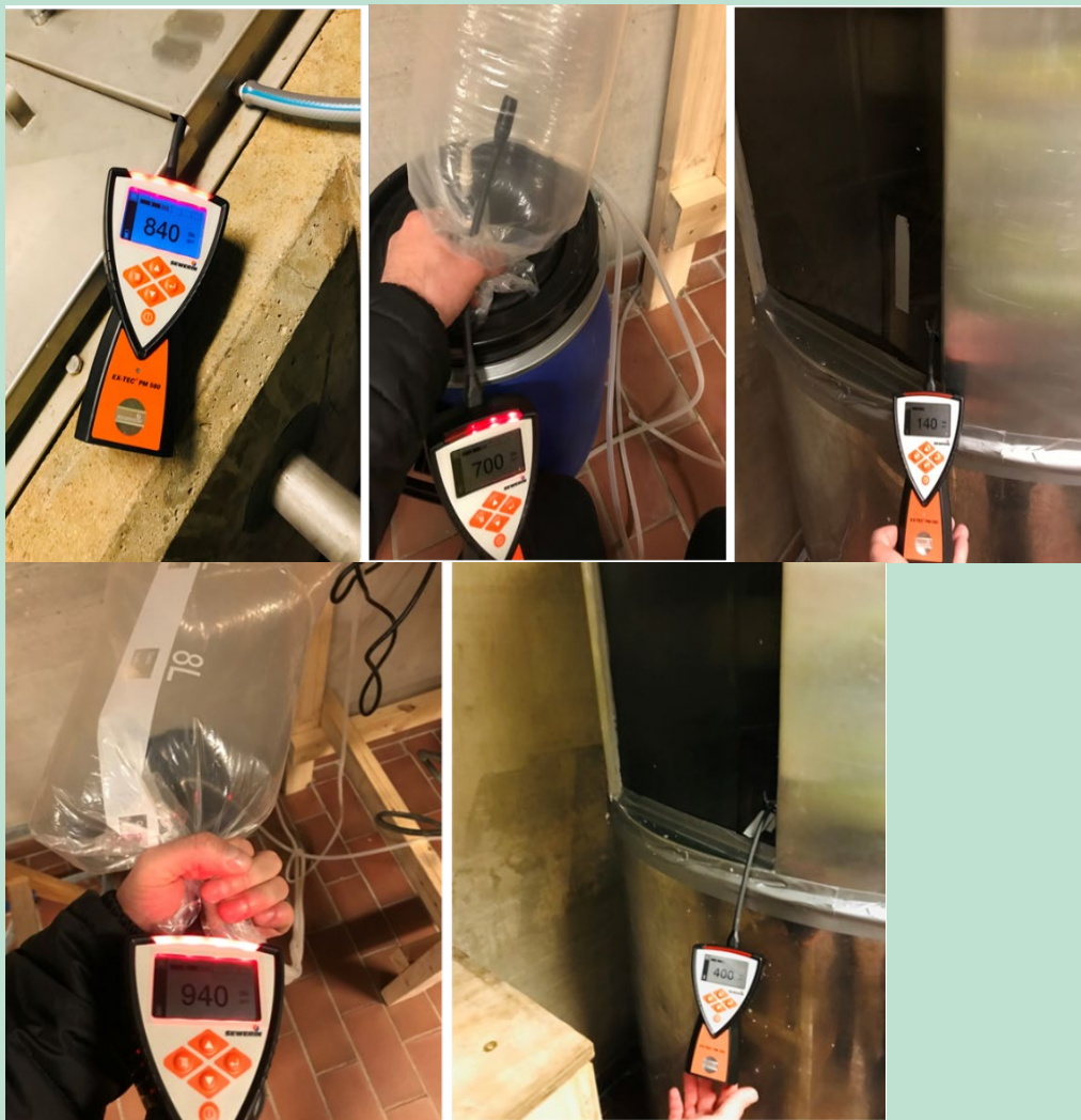
FIGUR 22. Måling af metanindhold i luften på de udvalgte steder. Iltningsbassin på vandværket (venstre), indløbsluft til BioBox'en efter H_2S -fælden (midten) og over skumlagene i BioBox'en (højre). Alle målingerne viste betydelig fjernelse (>50 %) af metan i BioBox'en, uanset om metankoncentrationen i indløbsluften var fx 700 ppm eller 940 ppm.
