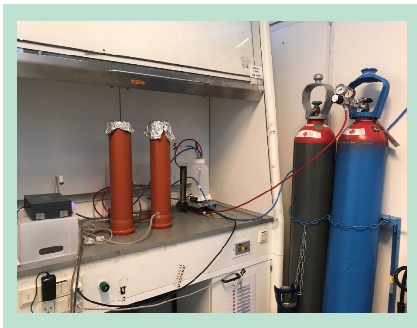
FIGUR 15. Opstilling af semitekniske kolonneforsøg i pilotskala i laboratorium. Atmosfærisk luft blandes med rent metan (flasken) for at danne en blanding med 50 ppm metan, som pumpes til bunden af hver kolonne. Metanreduktion måles med INNOVA i luftfasen over skumlagene. Vandpumpe tilfører periodisk vand (50 ml) med NPK og kobber (beskrevet ovenfor).
