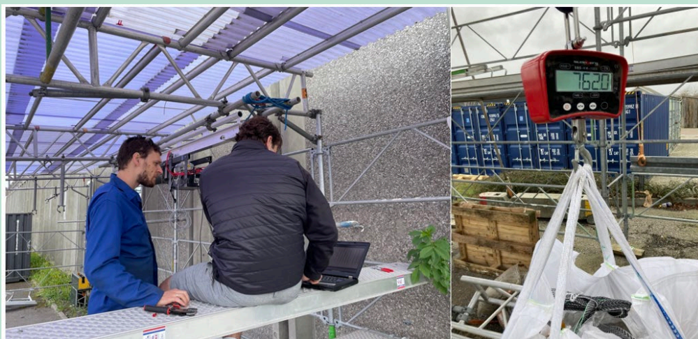
FIGUR 8. Måling af strømstyrke ved løft på intern test set up (tv). Vejecelle anvendes ved test.
